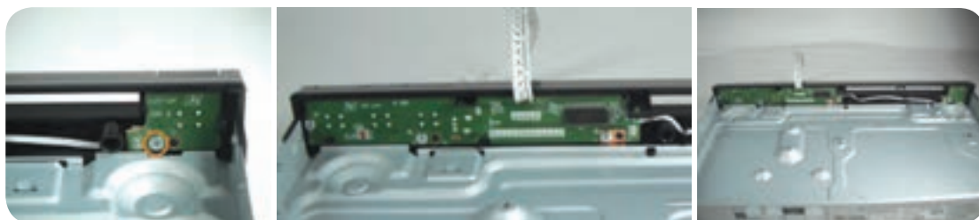
شکل ۶-۲۷ قرار دادن برد مدار چاپی شکل ۶-۲۸ باز کردن ۳ پیچ پنل بزرگ شکل ۶-۲۹ پیچ پنل کوچک
