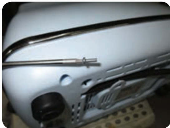
شکل ۶-۴۳ استفاده از ابزار خاص برای پیچ‌های ویژه
