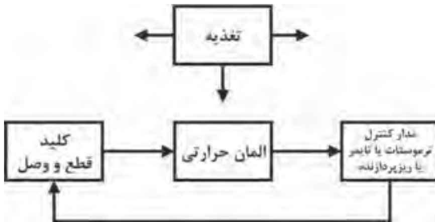
شکل ۶-۳۸ بلوک دیاگرام توستر
