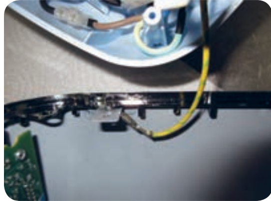
الف ب شکل ۵۶- محل اتصال سیم زمین به نقاط مختلف توستر
