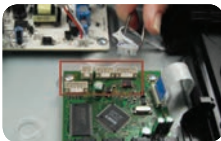
شکل ۱۹-۶ جدا کردن سوکت‌ها از برد پردازشگر
