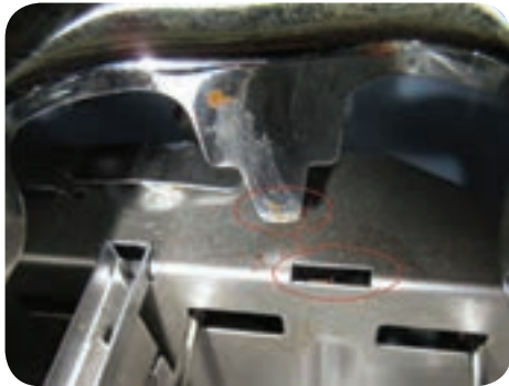
شکل ۵۸- خار نر و ماده جهت اتصال
