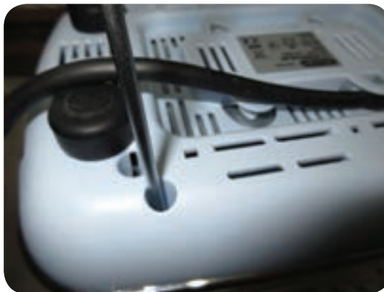
شکل ۶-۴۲ تشخیص نوع و محل پیچ‌های باز شده
