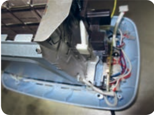
الف ب شکل ۵۶- محل اتصال سیم زمین به نقاط مختلف توستر
