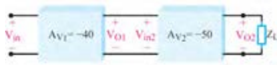
شکل ۳۶-۱۰- بلوک دیاگرام دو طبقه تقویت کننده
