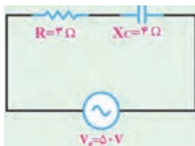
شکل ۹-۱۸- مدار RC سری
