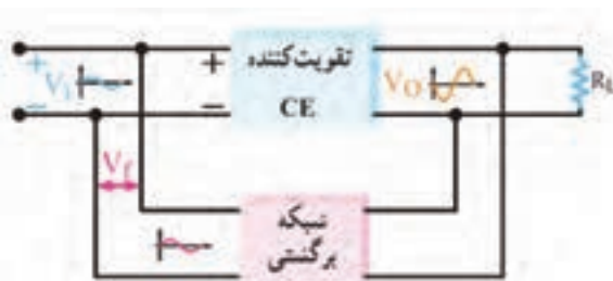
شکل ۱۶-۱۰. بلوک دیاگرام تقویت کننده با فیدبک
