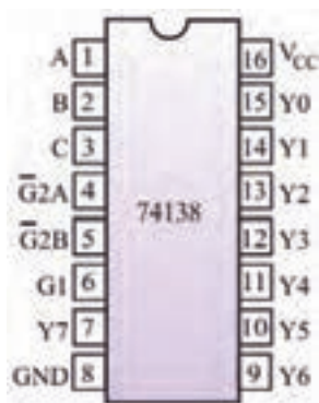
شکل ۶-۷- مشخصات پایه‌های آی سی ۷۴۱۳۸
