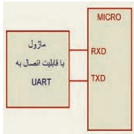
شکل ۴-۲۲- اتصال ماژول به میکروکنترلر
