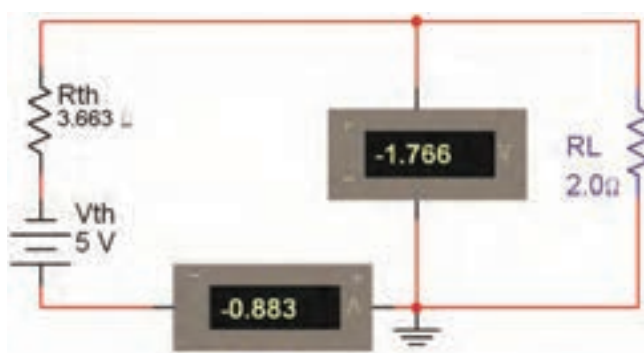
شکل ۸-۱۳- اندازه‌گیری جریان بار در مدار معادل تونن
