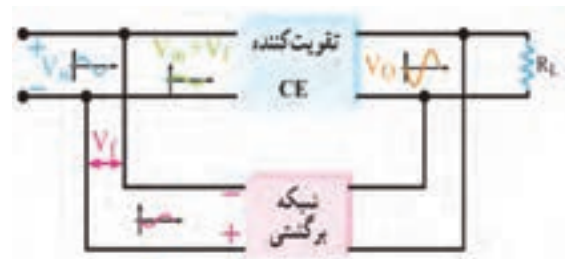
شکل ۱۸-۱۰. بلوک دیاگرام تقویت کننده با فیدبک منفی
