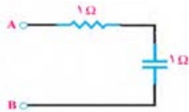
شکل ۹-۶۸- مدار RC سری
