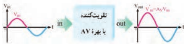
شکل ۱۰-۳۲- مدل بلوکی تقویت کننده
