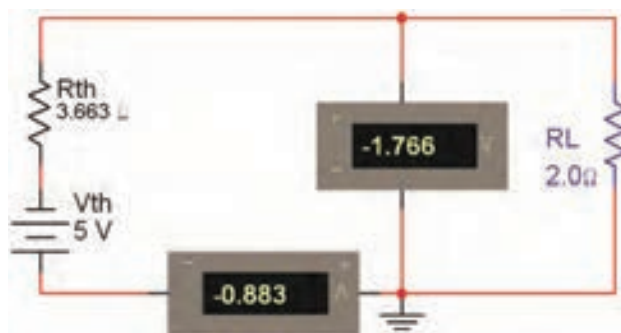
شکل ۸-۱۲- اندازه‌گیری جریان عبوری از مقاومت
