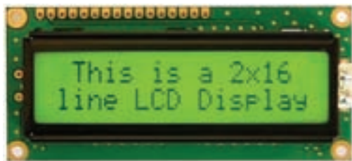
شکل ۴-۵- LCD کاراکتری ۲×۱۶
