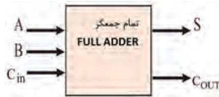
شکل ۹-۶ مدار بلوکی تمام جمع گر
