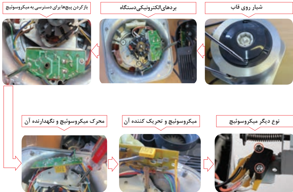
شکل ۲۵-۱- اینفوگرافی جدا کردن میکروسوییچ
