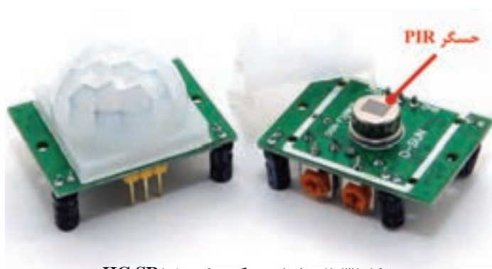
شکل ۲-۳۲- ماژول حسگر حرکتی HC-SR501
