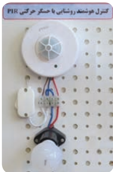
شکل ۲۹-۲ نحوه سیم‌کشی حسگر حرکتی PIR
