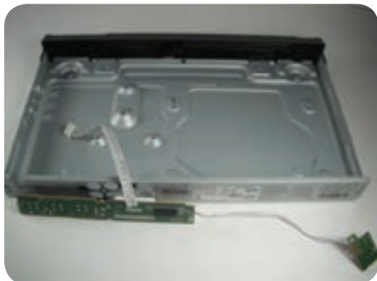
شکل ۶-۳۷ دمونتاژ پنل‌ها
