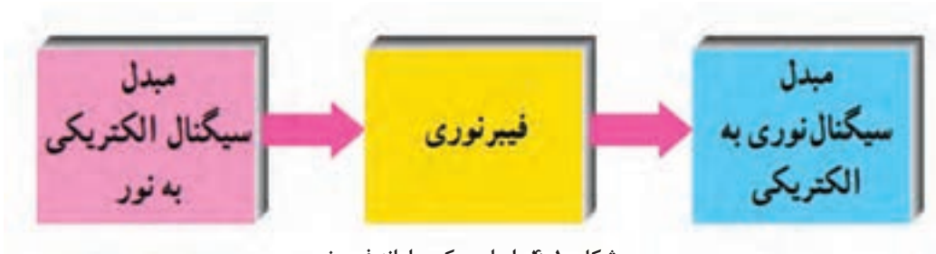
شکل ۴-۱۰- اساس یک سامانه فیبر نوری
