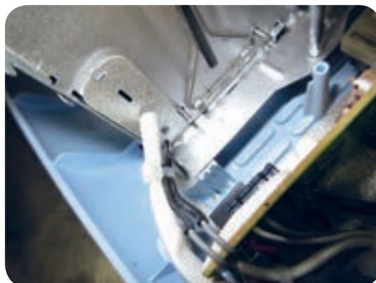
شکل ۶-۴۹ محل قرار گرفتن حسگر حرارتی
