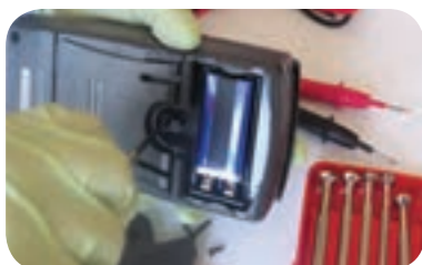
شکل ۱۴-۱ باز کردن پیچ‌ها و آزادسازی خارها
