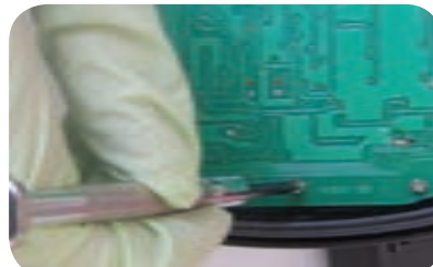
شکل ۱۶-۱ باز کردن پیچ‌های اتصال بدنه
