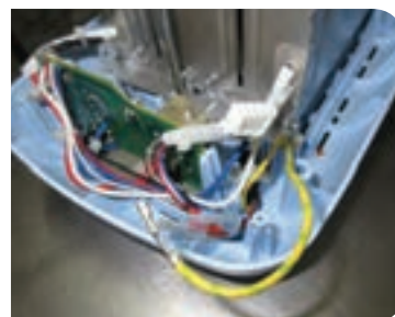
شکل ۶-۵۳ سیم اتصال زمین
