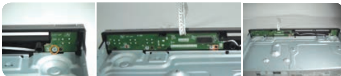
شکل ۶-۲۹ پیچ پنل کوچک شکل ۶-۲۸ باز کردن ۳ پیچ پنل بزرگ شکل ۶-۲۷ قراردادن برد مدار چاپی
