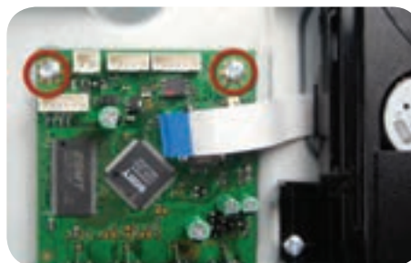
شکل ۶-۲۱ باز کردن پیچ‌های اتصال دهنده برد پردازشگر به کف دستگاه
