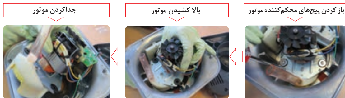
شکل ۲۶-۱- اینفوگرافی جدا کردن موتور
