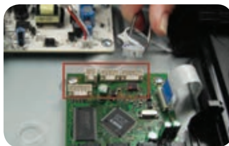
شکل ۶-۱۹ جدا کردن سوکت‌ها از برد پردازشگر
