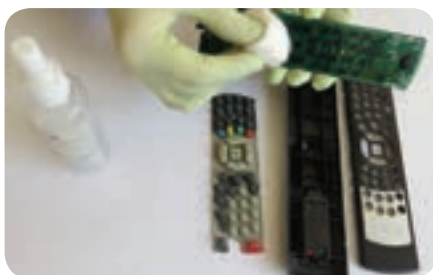
شکل ۱-۱۰ تمیز کردن کنتاکت‌ها با الکل
