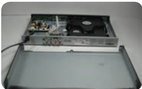
شکل ۶-۱۷ قاب پایینی جدا شده است
