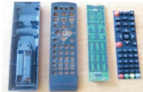
شکل ۱-۳ اجزای دستگاه ریموت کنترل
