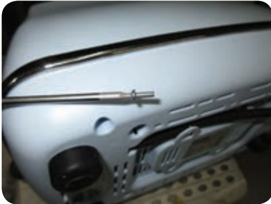
شکل ۶-۴۳ استفاده از ابزار خاص برای پیچ‌های ویژه
