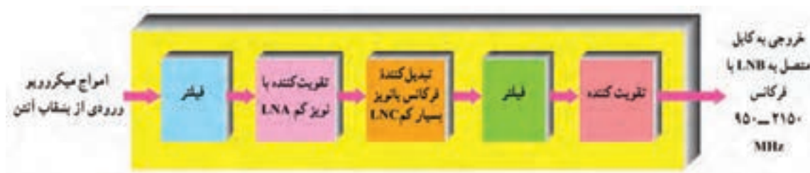
شکل ۴-۲۶ بلوک دیاگرام ساده LNB
