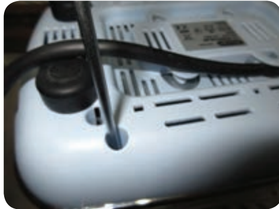
شکل ۶-۴۲ تشخیص نوع و محل پیچ‌های باز شده
