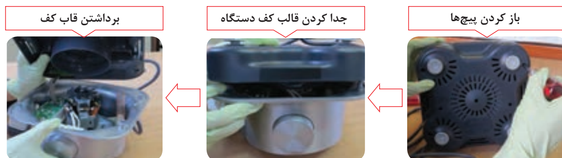
شکل ۲۲-۱. اینفوگرافی باز کردن کف دستگاه
