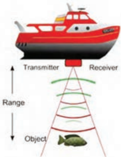
شکل ۱۹- نحوه کاربری سونار فعال
