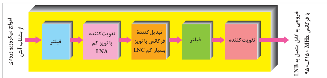
شکل ۲۱- بلوک دیاگرام ساده LNB
