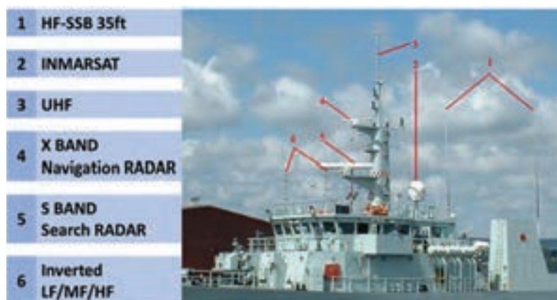
شکل ۱۷- موقعیت نصب آنتن‌ها در کشتی
