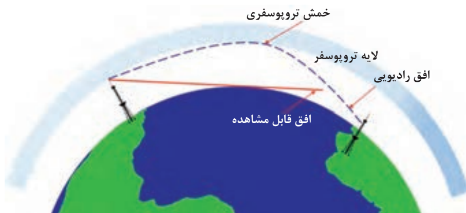
شکل ۸ - تفاوت افق رادیویی و افق قابل مشاهده
