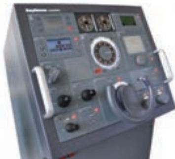
شکل ۲۶- سامانه هدایت خودکار (اتوپیلوت) در کشتی‌ها
