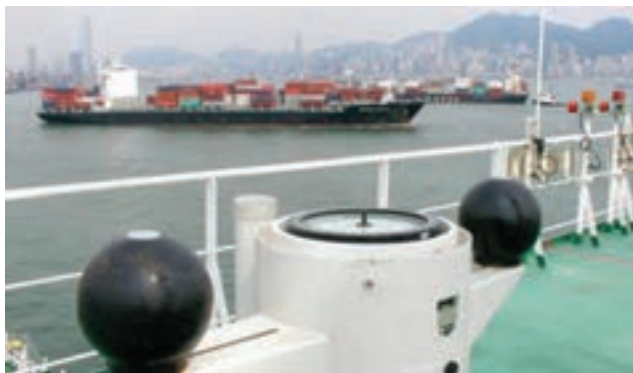
شکل ۲- پایه و گویچه‌های تنظیم‌کننده قطب‌نمای مغناطیسی
