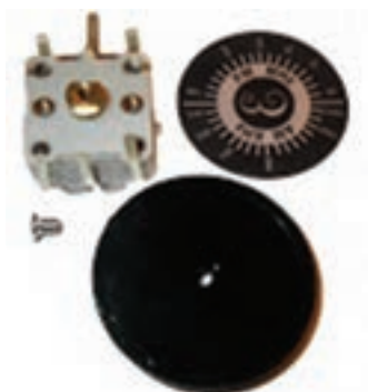
خازن متغیر و اجزای آن
