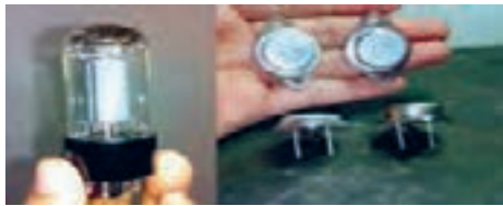
شکل ۱- مقایسه شکل ظاهری ترانزیستور و لامپ
