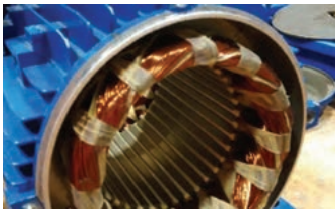
شکل ۳- استاتور موتورهای سه فاز
