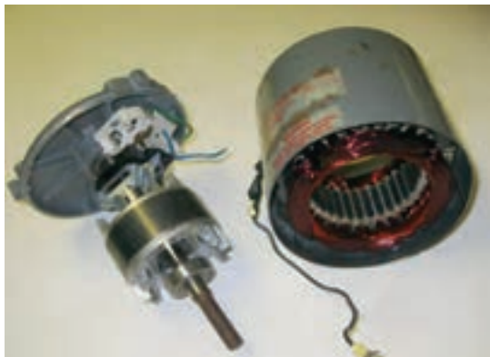
شکل ۲۰- موتور القایی تک فاز، فاز شکسته
