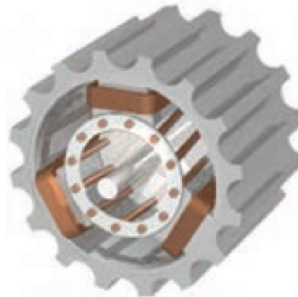
شکل ۵- حوزه دوار در سطح استاتور
