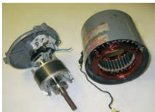
شکل ۱۸- رتور و استاتور موتور تک فاز
