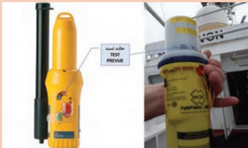
شکل ۳۸- تست دستگاه SART
