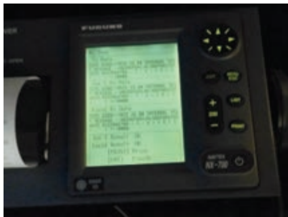
شکل ۴۴- آزمون دریافت کنندگی (RX) دستگاه NAVTEX
