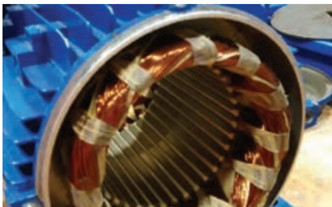
شکل ۳- استاتور موتورهای سه فاز
