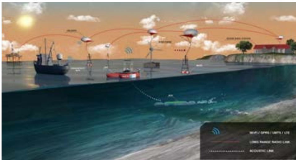
شکل ۲۸- تبدیل امواج صوتی به امواج الکترومغناطیسی
