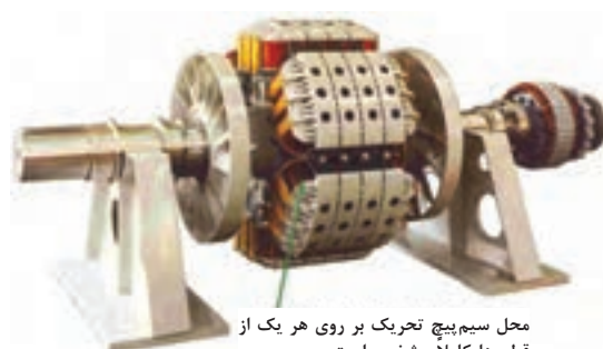
شکل ۱۲- رتور قطب برجسته
