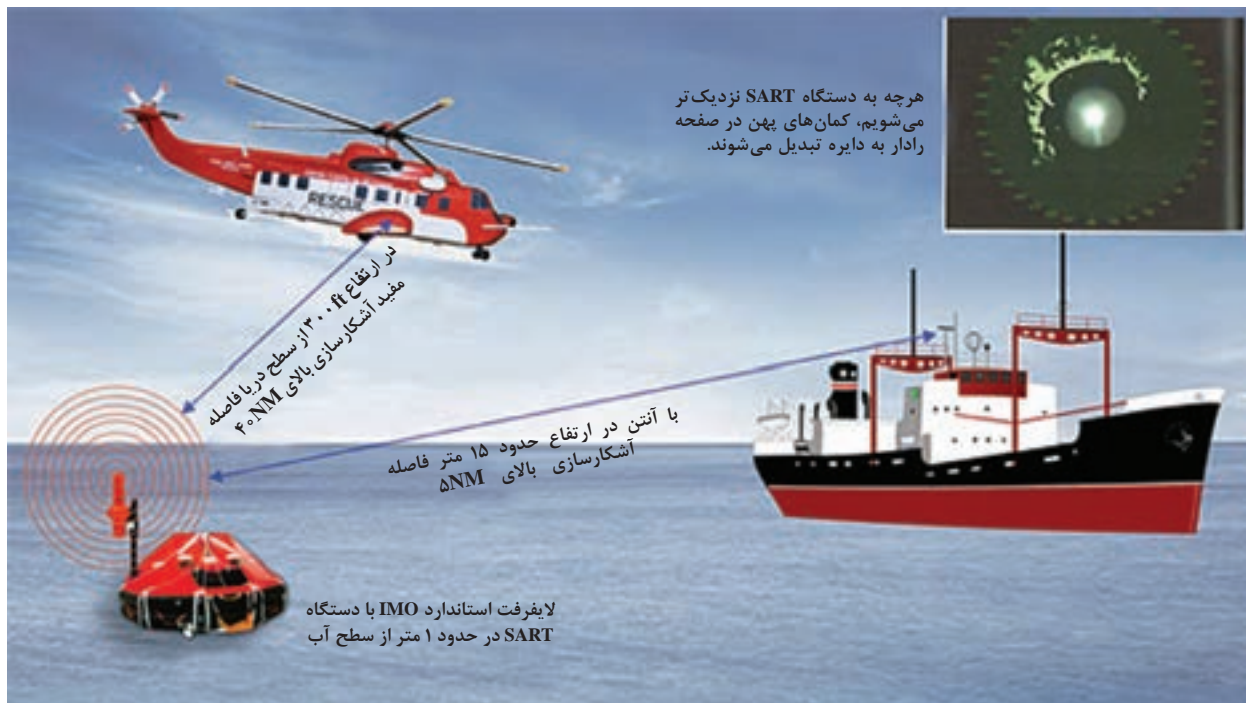
شکل ۲۰- عملکرد دستگاه RADAR SART
