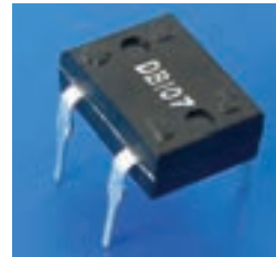
پل یک سوساز در بسته بندی آی‌سی
