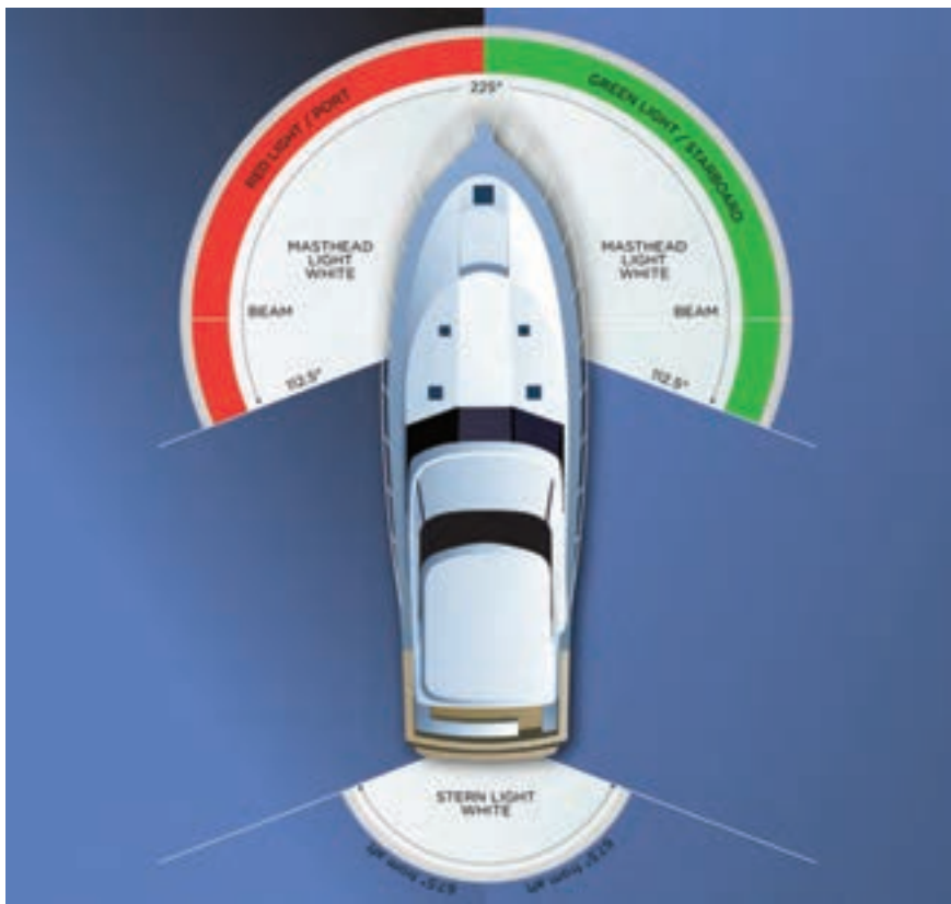
شکل ۲۹- الگوی قرارگیری چراغ‌های ناوبری بر روی کشتی‌ها و قایق‌ها
