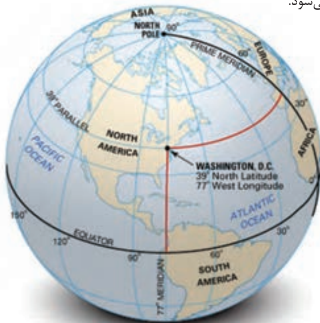
شکل ۸- مشخص کردن یک نقطه روی زمین با استفاده از طول و عرض جغرافیایی
