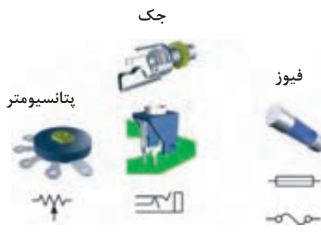
فیوز، جک گوشی، پتانسیومتر و شمای فنی آنها
