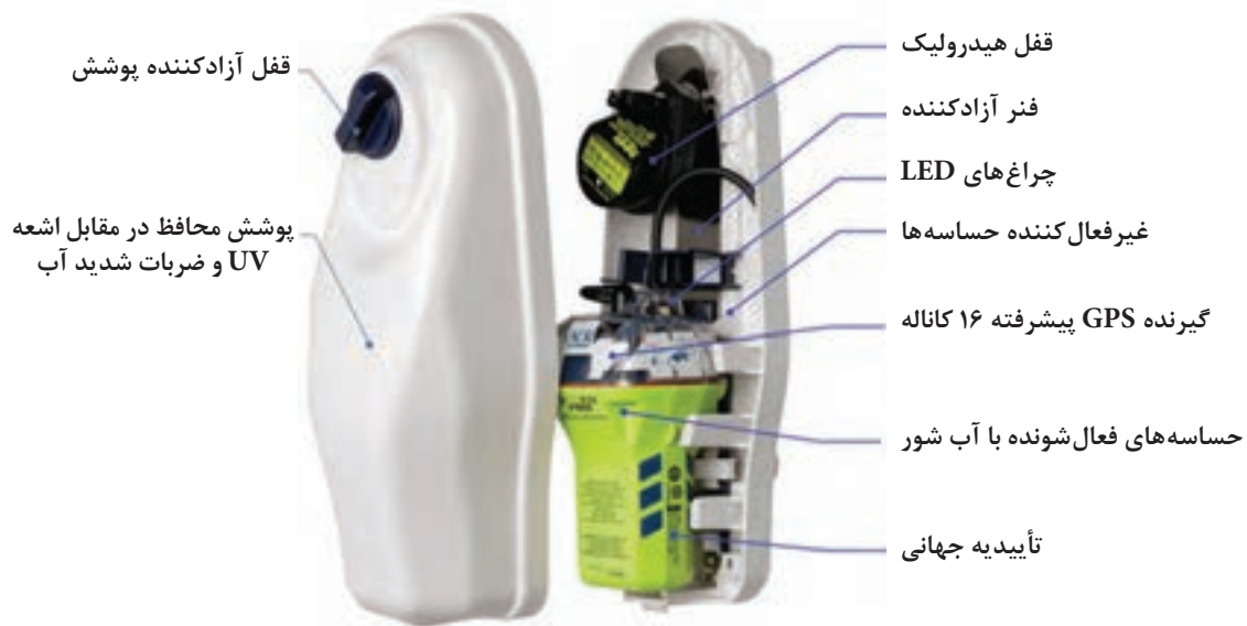
شکل ۱۱- اجزای تشکیل دهنده دستگاه EPIRB
