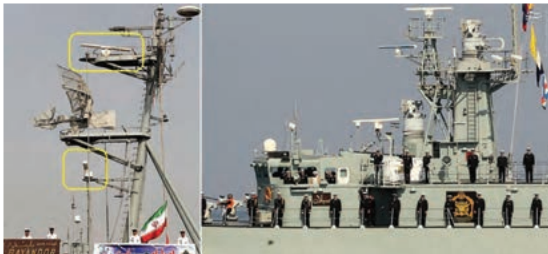
شکل ۲۰- رادارهای S-BAND و X-BAND
