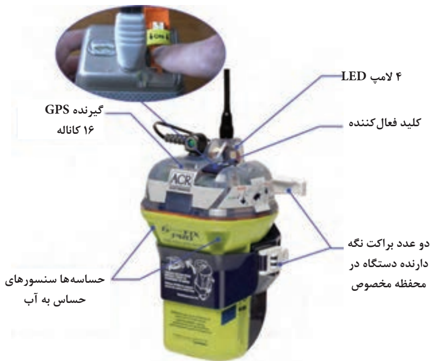
شکل ۱۳- اجزای مختلف دستگاه EPIRB
