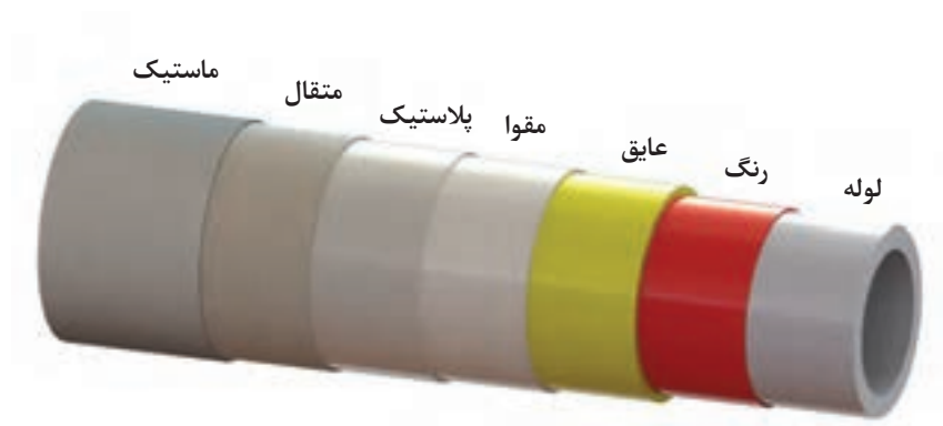
شکل ۱۳- لایه های عایق پشم شیشه
