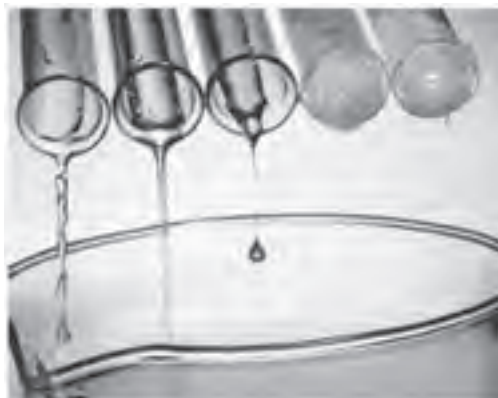
شکل ۱- مقایسه روانی جریان سیالات با لزجت متفاوت
