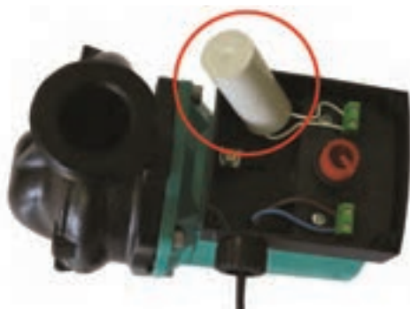
شکل ۳۵- خازن در جعبه برق موتور
