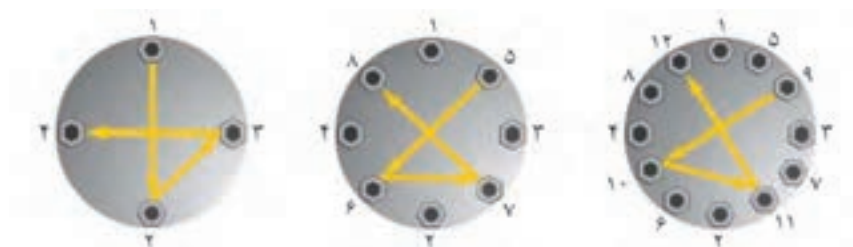
شکل ۲۳- ترتیب سفت کردن پیچ‌های فلنج
