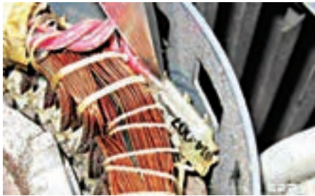
شکل ۳۶- محافظ حرارتی سیم پیچ موتور
