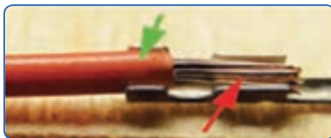
شکل ۱۱- جازدن سر سیم در سیم افشان
