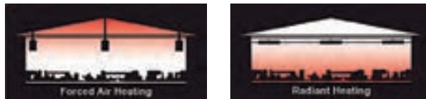
شکل ۷- مقایسه گرمایش تابشی با یونیت هیتر
