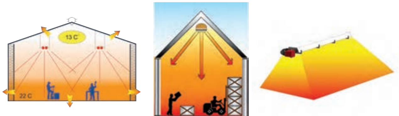
شکل ۵- سیستم گرمایش تابشی
