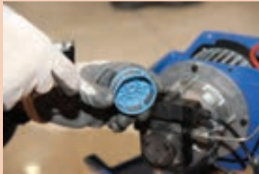
بازکردن درپوش پمپ و تمیز کردن فیلتر
