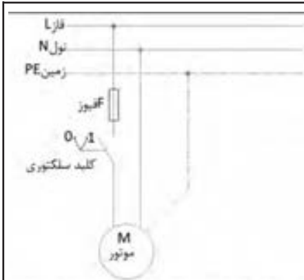
مدار برق موتور یونیت هیتر با کلید سلکتوری دو حالته
