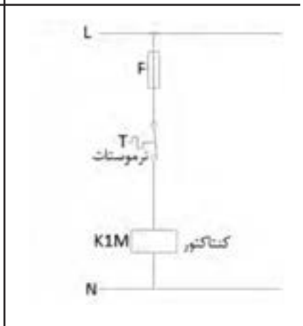
مدار برق موتور یونیت هیتر با کنتاکتور و ترموستات
