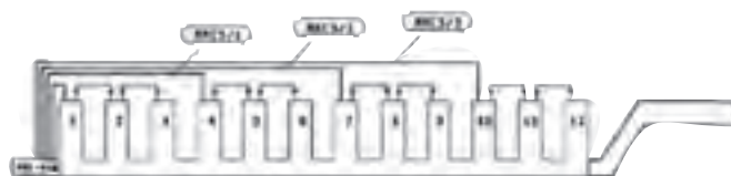
شکل ۲۴- نحوه ارتباط واحدهای ماشین چاپ (یونیت‌های چاپ) به یکدیگر و هاب
