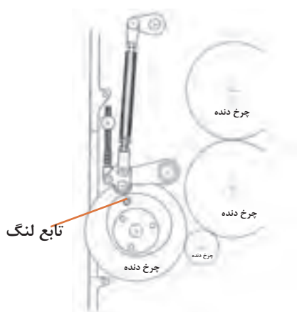
شکل ۳۲-ب) مکانیزم حرکتی سنجاق
