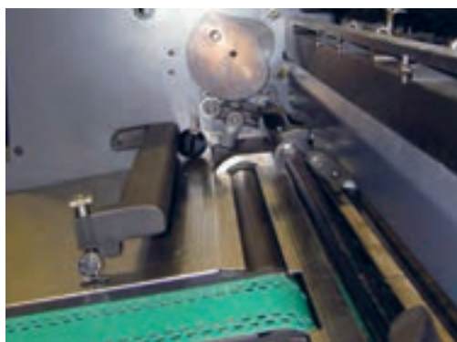
شکل ۱۲- لنگ (بادامک) دیسکی
