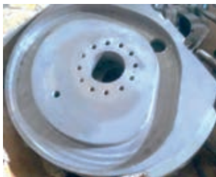
شکل ۱۴-پ) یک لنگ شیاردار در ماشین دایکات
