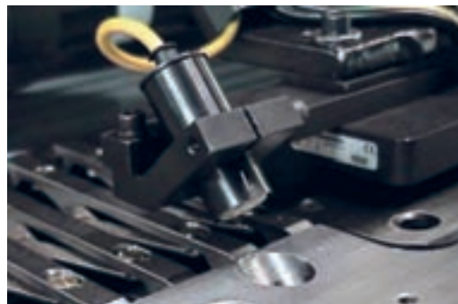
شکل ۱۴- سنسور دوتایی بگير اولتراسونیک
