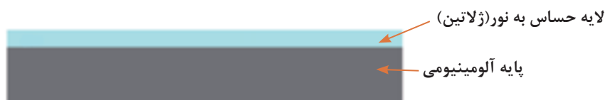
شکل ۲۰- ساختمان پلیت Azura TE
