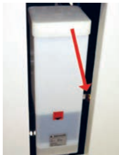
شکل ۱۲- حسگر تشخیص سطح روغن
