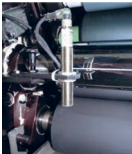
شکل ۱۱- حسگر سنجش سطح آب
