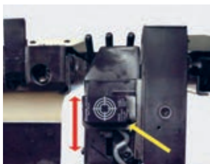
شکل ۱۵- سنسور تشخیص کاغذ در واحد تغذیه
