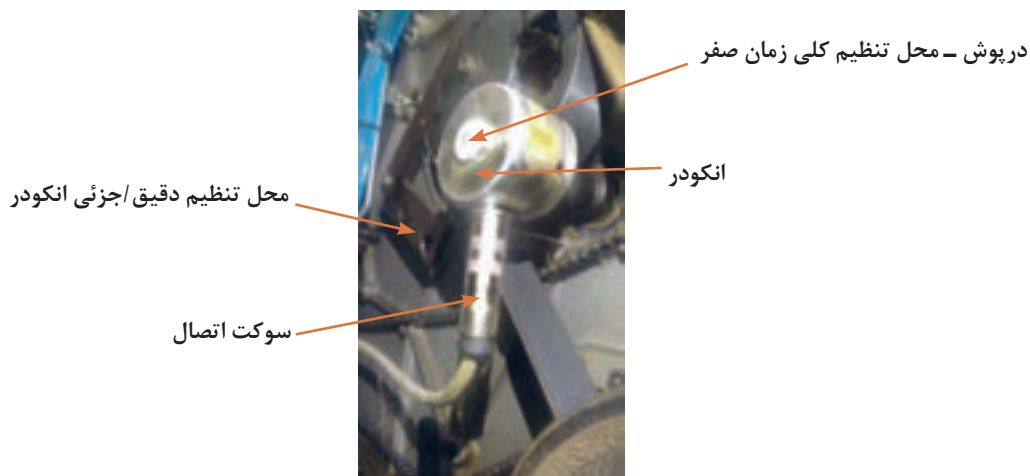
شکل ۲۵- ساختمان یک انکودر در ماشین چاپ
