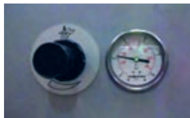
شکل ۵۴- دستگیره تنظیم فشار و گیج آن
