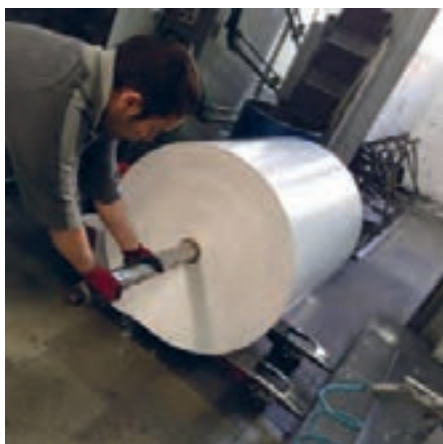
شکل ۳۴- قرار دادن شفت بادی درون بوبین دستگاه
