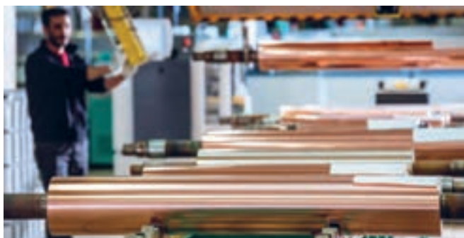
شکل ۴۳- جابه‌جایی سیلندر توسط بالابر
