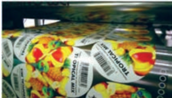
شکل ۹- چاپ از رو بر روی فویل آلومینیوم
