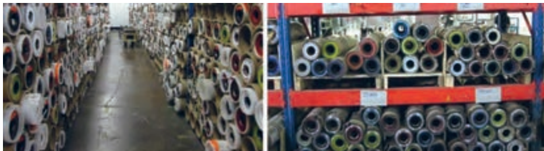
شکل ۹- نگهداری سیلندرها بدون شفت
