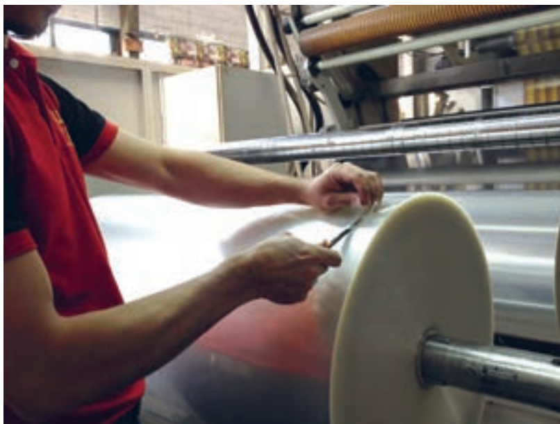
شکل ۱۶- بریدن لایه‌های خراب شده
