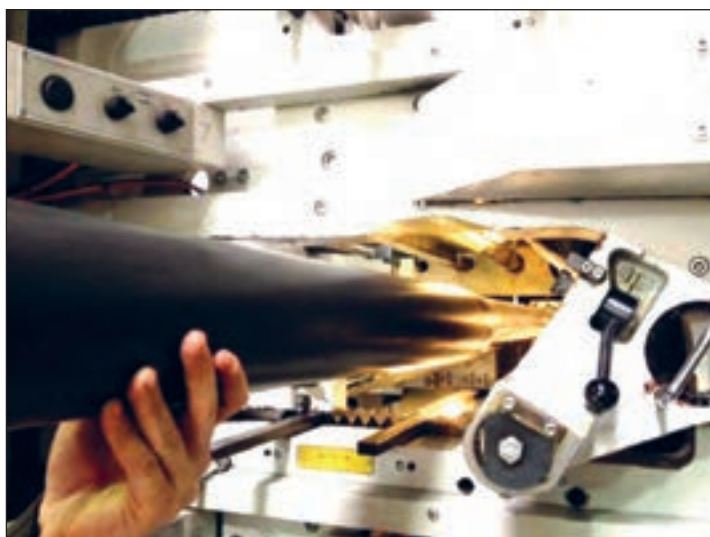
شکل ۳۲- قرار دادن آداپتور بر روی شفت
