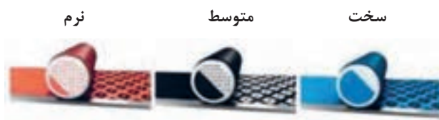
شکل ۱۱- شماتیک فشردگی ذرات فوم چسب پایه
