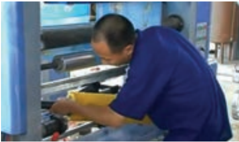
شکل ۶۵- نصب پرس رول سمت موتور
