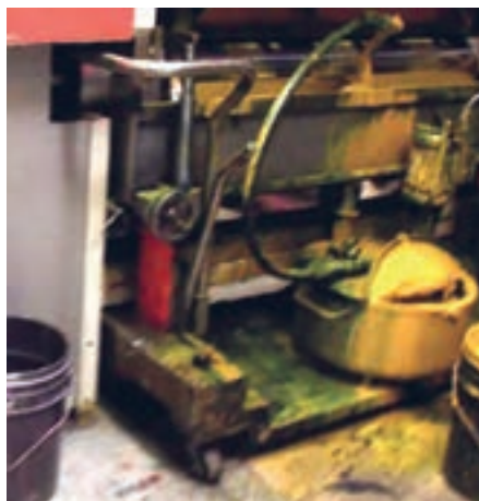
شکل ۴۸- سر ریز شدن مرکب
