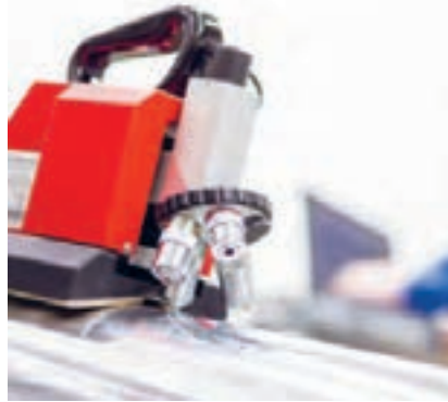
شکل ۳۶- میکروسکوپ کنترل اندازه دیواره سلول‌ها
