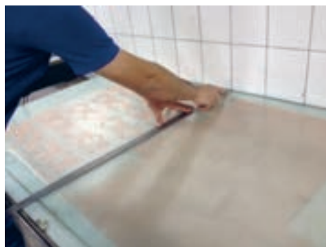
شکل ۹- نحوه برش کلیشه
