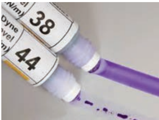
شکل ۲۹- مقایسه جوهر بالاتر از عدد مربوطه بر روی سطح آماده‌سازی شده
