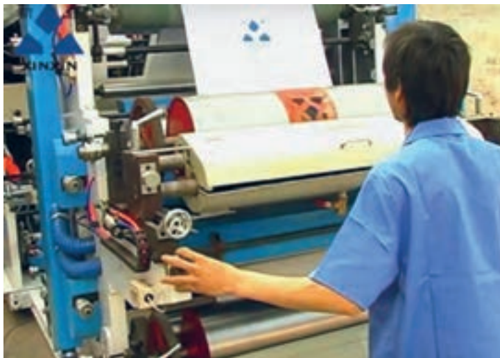
شکل ۲- تنظیم فشار پلیت و سیلندر چاپ
