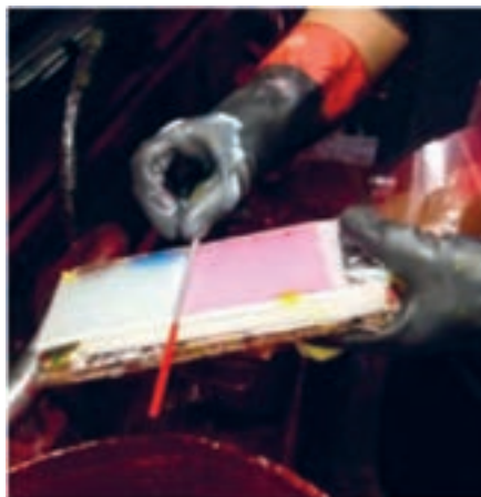
شکل ۱۵- نحوه برداشتن نمونه رنگ ترکیب شده
