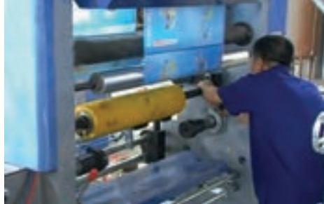
شکل ۶۴- نصب پرس رول سمت اپراتور
