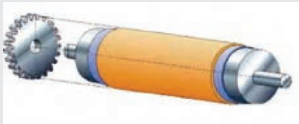
شکل ۲۹- سیلندر كليشه و چرخ دنده متناسب آن
