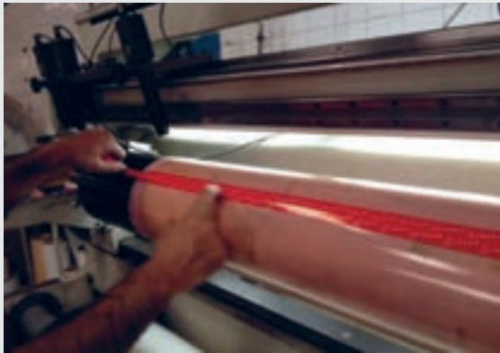
شکل ۲۸- نحوه چسباندن چسب لبه کلیشه
