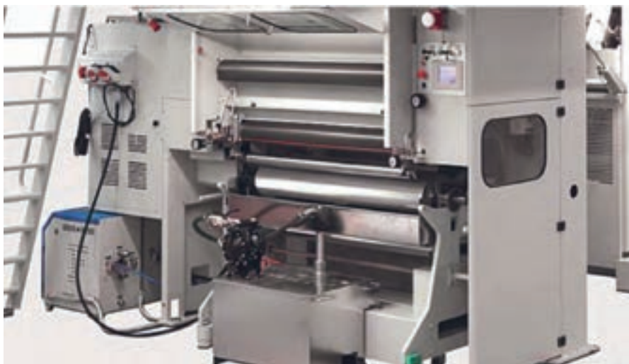
شکل ۴۰- کنترل اتوماتیک گرانروی مرکب
