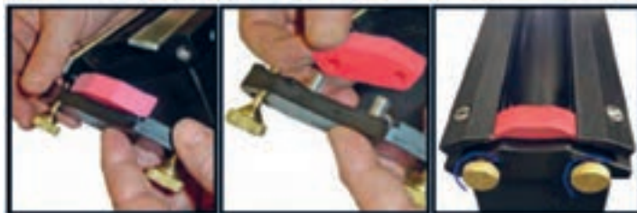
شکل ۱۱- نصب محافظ‌های خروج مرکب
