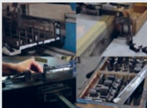
شکل ۱۰۲- خم کن با قطعات مختلف آن
