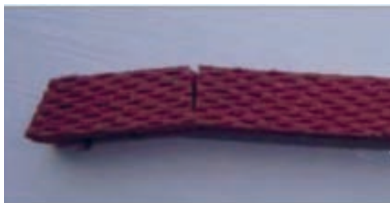
شکل ۱۴۷- لاستیک با درجه شور نامناسب
