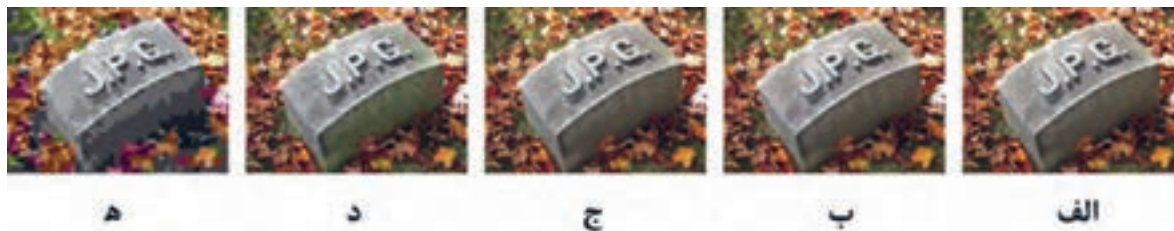
شکل ۲۱- تأثیر میزان فشردن سازی بر افت کیفیت در فشردن سازی به شیوه JPEG
