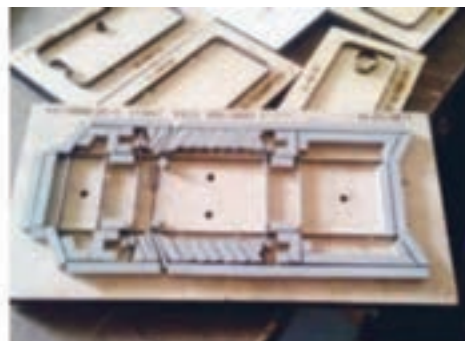
شکل ۱۷- قالب برش تخت
