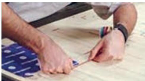
شکل ۹۳- نحوه چسباندن طرح روی قالب
