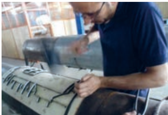
شکل ۱۳۴- جا زدن تیغ‌ها با چکش
