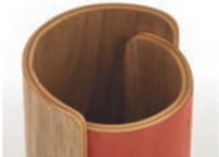
شکل ۱۳- ویژگی انعطاف پذیری تخته‌های چند لایه
