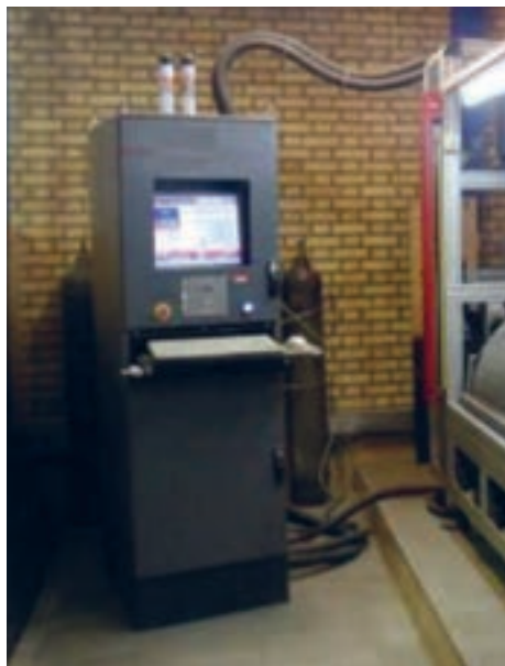
شکل ۱۲۴- ارائه طرح به دستگاه برش لیزری
