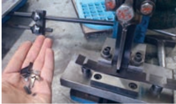
شکل ۹۶- دستگاه جداکننده پل روی تیغ
