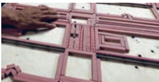
شکل ۱۲۲- قرار دادن لاستیک‌های جدا کننده روی قالب
