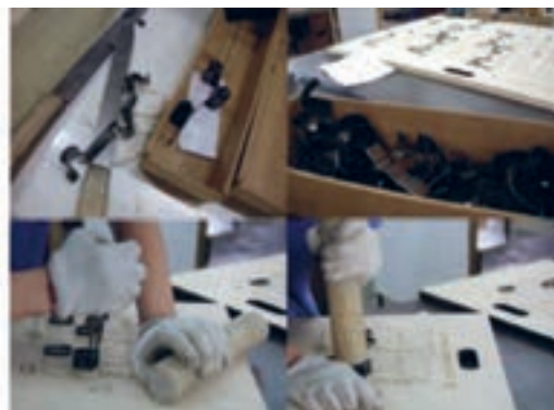
شکل ۱۰۴- قرار دادن تیغ‌ها در قالب
