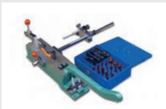
شکل ۱۰۳- دستگاه خم کن دستی
