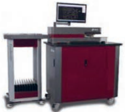
شکل ۱۱۸- دستگاه خودکار برش و خم کن
