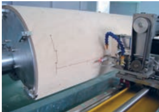
شکل ۱۲۶- برش تخته قالب با دستگاه اره CNC
