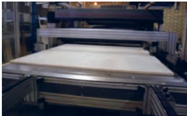
شکل ۱۱۵- تخته قالب در دستگاه قرار داده شده
