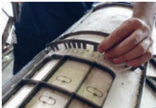
شکل ۱۳۳- قرار دادن تیغ‌ها در سیلندر
