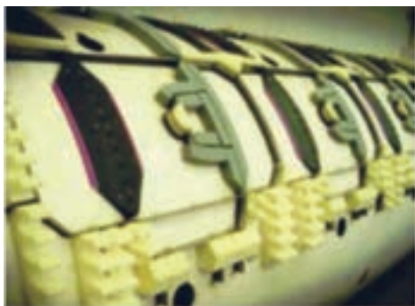
شکل ۱۸- قالب برش گرد یا روتاری
