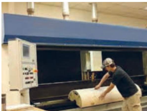
شکل ۱۲۳- قرارگیری سیلندر در دستگاه برش
