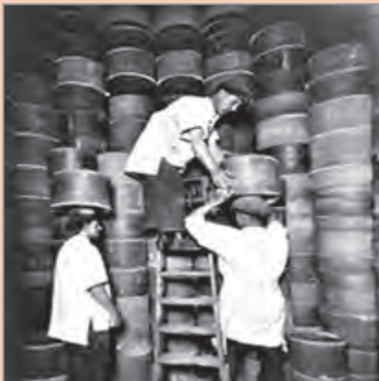
شکل ۶۷ - چیدمان ستونی ساگارها در کوره‌های سنتی
