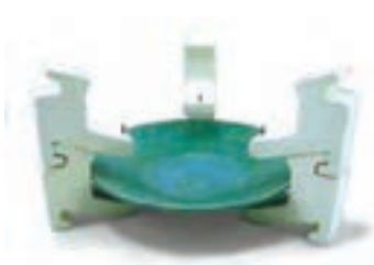
شکل ۵۴- مونتاژ چنگک پین دار برای پخت بشقاب لعاب خورده
