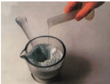
شکل ۳۴- افزودن آب به آمیز لعاب
