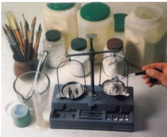
شکل ۳۲- وزن کردن آمیز لعاب
