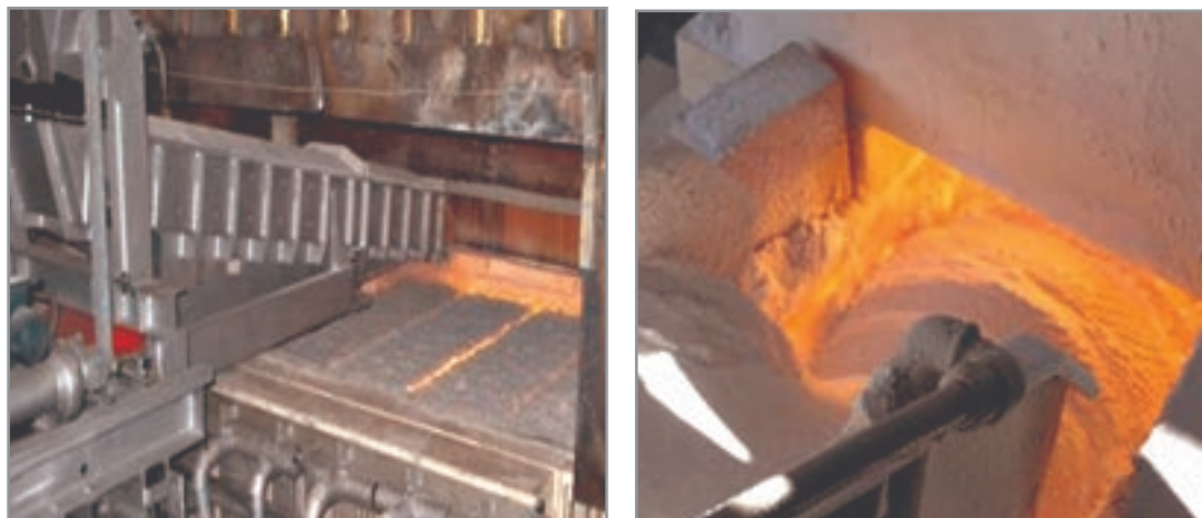
شکل ۲۳- ریختن آمیز به درون کوره
