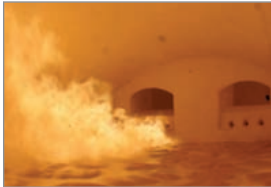
الف) مخزن ذوب کوره ریجنراتوری پشت گذر
