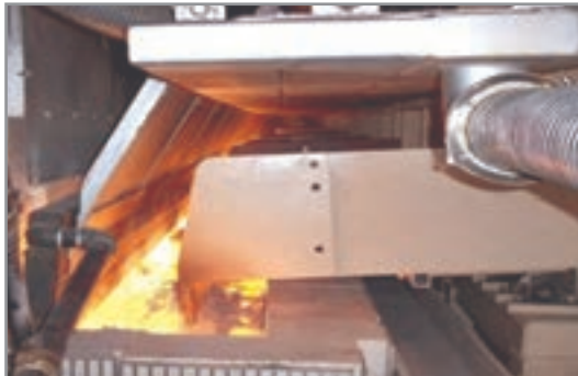
شکل ۱۷- دریچه بارریز کوره‌های شیشه تخت
