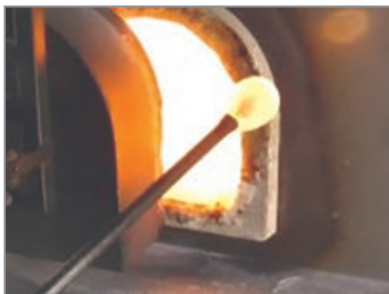
شکل ۹- برداشت بار از حوضچه بارگیر
