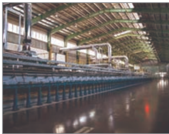
شکل ۳۰- گرمخانه تنش زدایی شیشه
