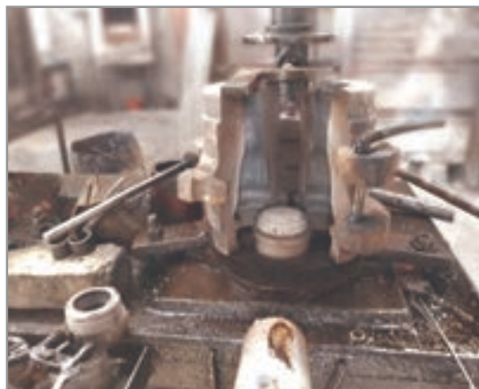
شکل ۱۳- قالب پرس بادی
