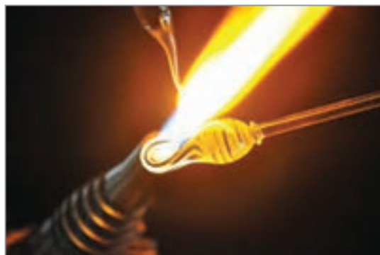
شکل ۱۴- شیشه‌گری با شعله
