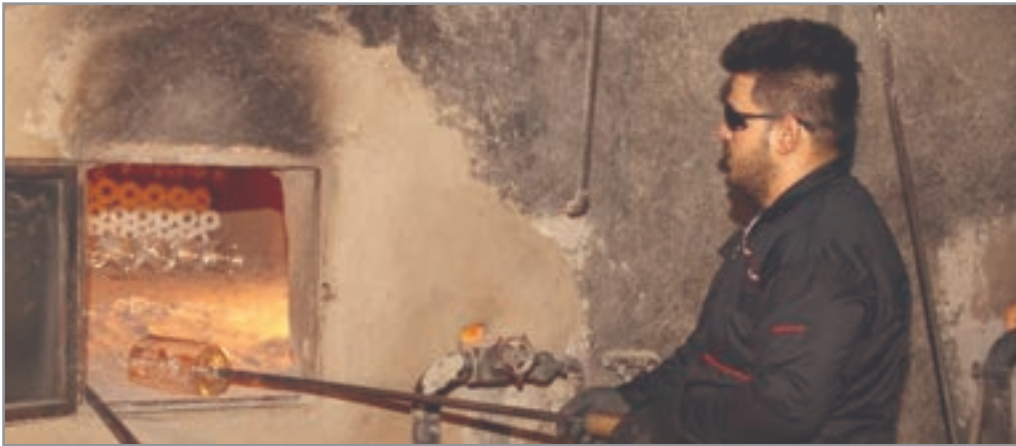
شکل ۹- قرارگیری شیشه در گرمخانه
