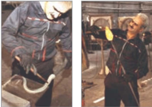
شکل ۷- شکل‌دهی گوی با کمک ابزار
