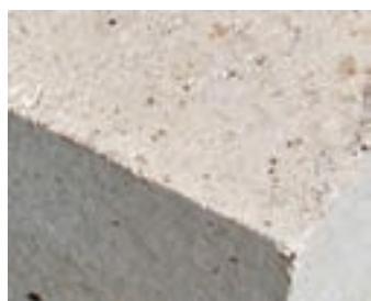
شکل ۱۲- آجر آلومینایی متراکم
