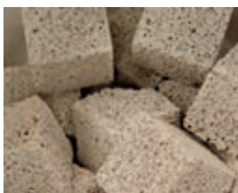
شکل ۱۱- آجر آلومینایی متخلخل
