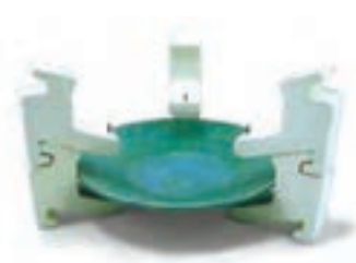
شکل ۵۴- مونتاژ چنگک پین دار برای پخت بشقاب لعاب خورده
