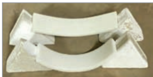
شکل ۳۰- آزمایش مقاومت پخت دو تکیه‌گاهی
