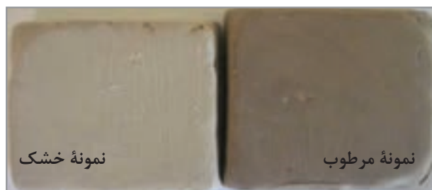
شکل ۲- تأثیر انقباض خشک در کاهش ابعاد نمونه
