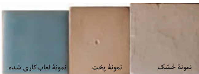
شکل ۱۲- تأثیر انقباض پخت بر ابعاد نمونه
