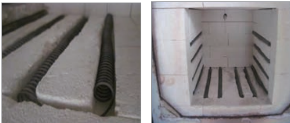
شکل ۱۳- نصب المنت درون شیار
