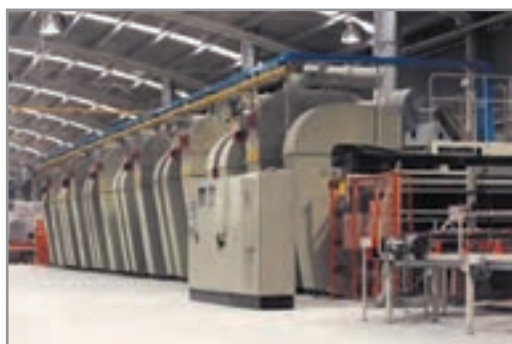
شکل ۱۴- خشک کن تونلی
