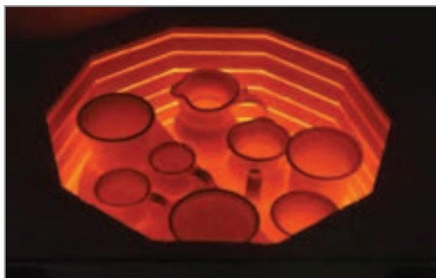
شکل ۲- بدنه‌های سرامیکی در حال پخت
