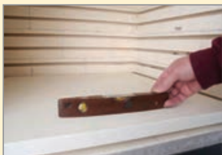
شکل ۲۸- بررسی تراز بودن کف کوره کارگاهی
