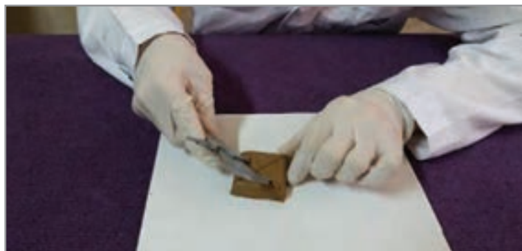
شکل ۸- علامت‌گذاری به وسیله کولیس
