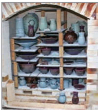
الف) قفسه بندی کوره برای پخت قطعات بیسکویت ب) قفسه بندی کوره برای پخت قطعات لعاب خورده
