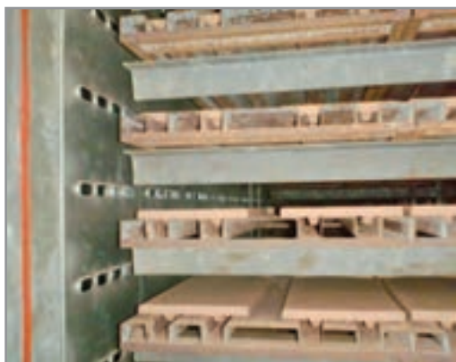
شکل ۱۶- دمش هوا از روزنه ها به قطعه
