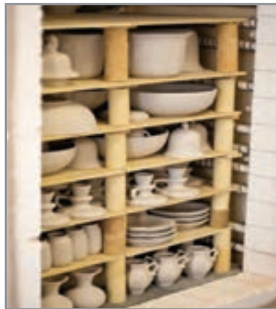
الف) قفسه بندی کوره برای پخت قطعات بیسکویت ب) قفسه بندی کوره برای پخت قطعات لعاب خورده
