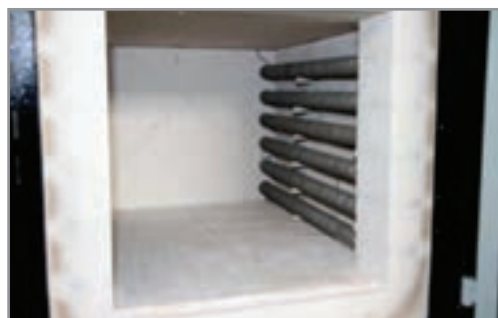
شكل ۱۲- نصب المنت بر روی پایه
