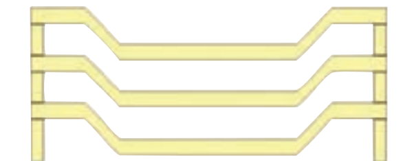
شکل ۴۶- حفظ فاصله بین سطح زیرین اولین ستر و کف
