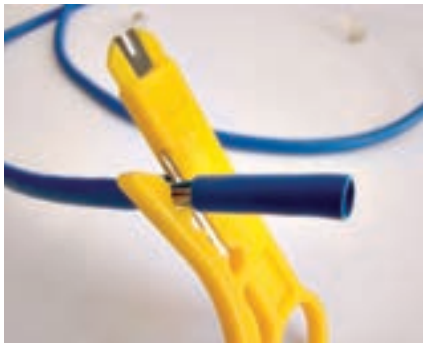
شکل ۲۵- لخت کردن سر کابل
