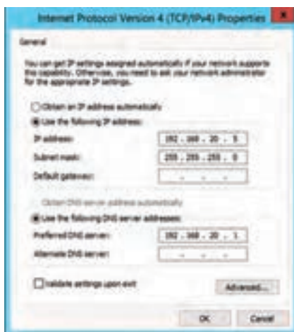
شکل ۴۳- تنظیم آدرس سرور DNS برای سرویس گیرنده
