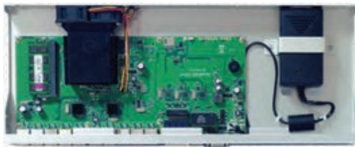
شکل ۴- نمای داخلی مسیریاب میکروتیک
