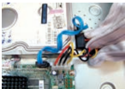
شکل ۳۴- اتصال کابل تغذیه دیسک سخت
