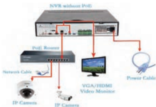
شکل ۱۷- اتصال دوربین به NVR
