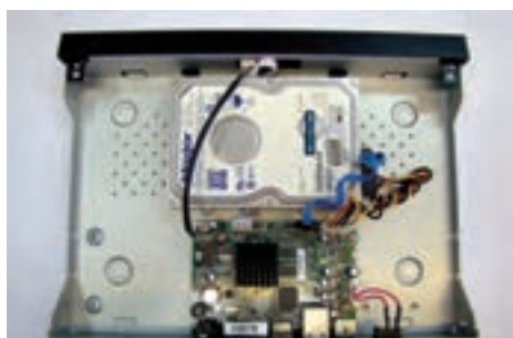
شکل ۳۵- محکم کردن دیسک سخت در محل نصب
