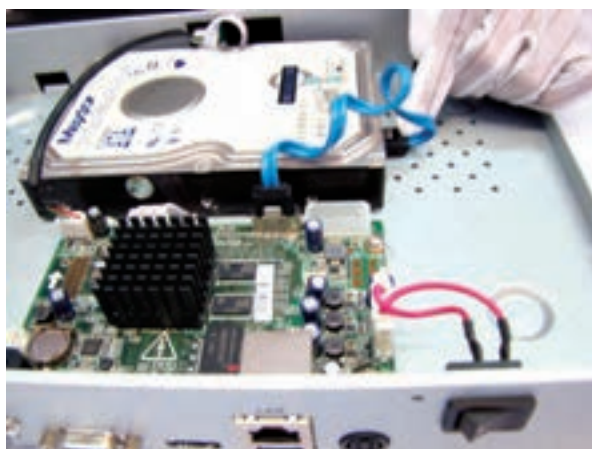
شکل ۳۳- اتصال کابل داده دیسک سخت
