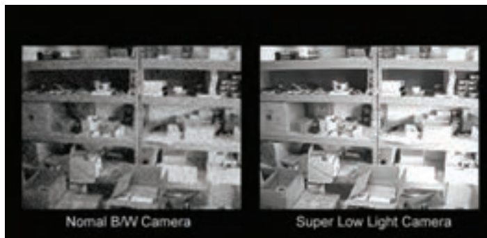
شکل ۱۸- تأثیر مشخصه Minimum Illumination در تصویر
