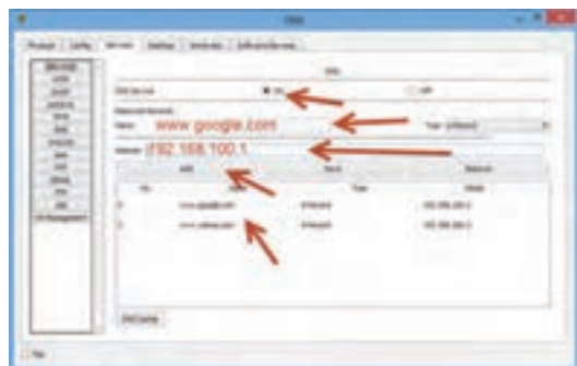
شکل ۴۰ – تنظیمات DNS Server
