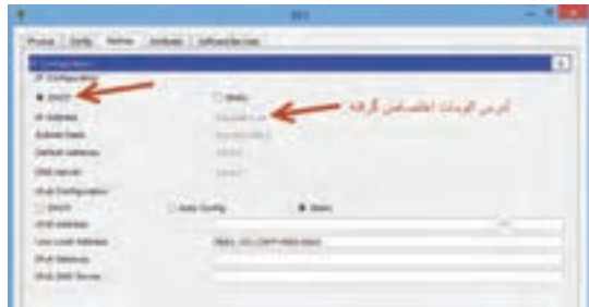
شکل ۳۰- تنظیم آدرس IP سرویس‌گیرنده‌ها در حالت خودکار
