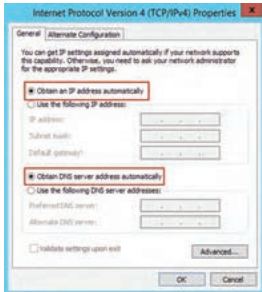
شکل ۳۴- تنظیم سرویس‌گیرنده برای دریافت آدرس از سرویس دهنده DHCP
