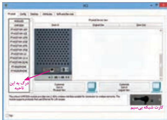
شکل ۱۸- برداشتن کارت شبکه
