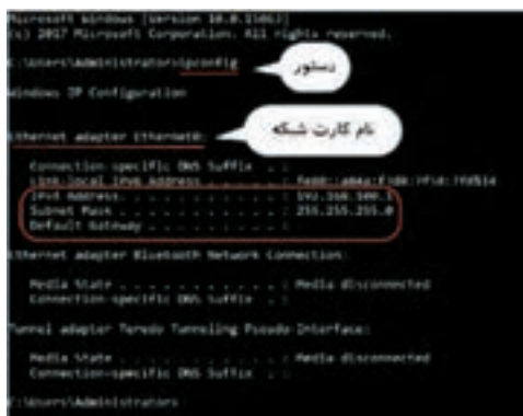
شکل ۲- اجرای دستور ipconfig بدون پارامتر
