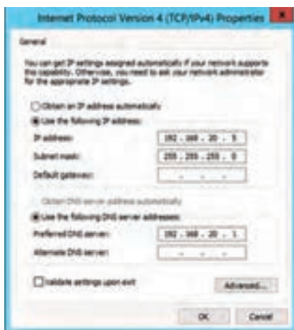
شکل ۴۳- تنظیم آدرس سرور DNS برای سرویس گیرنده
