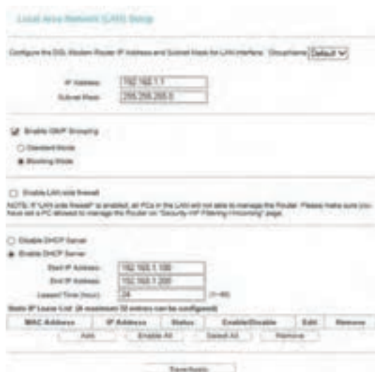
شکل ۵۷- تنظیمات DHCP مودم ADSL
