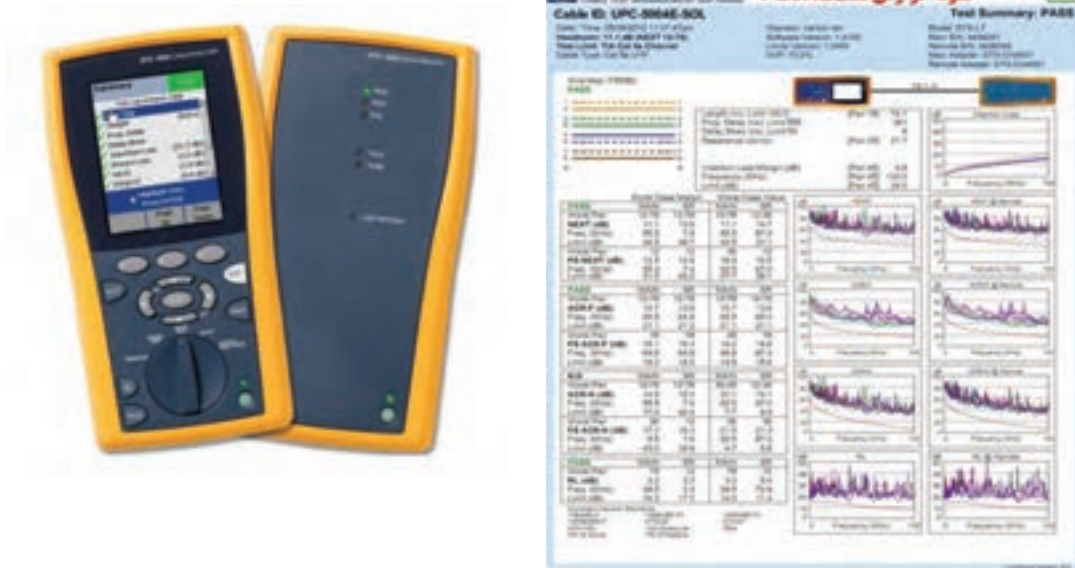
شکل ۱۹- تستر Fluke و نمونه‌ای از گزارش آن
