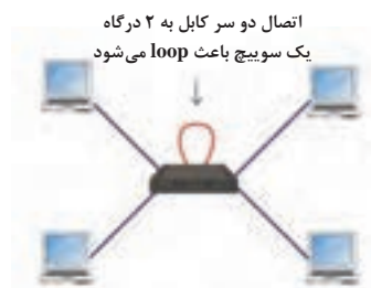
شکل ۵۹- وجود loop در سویچ
