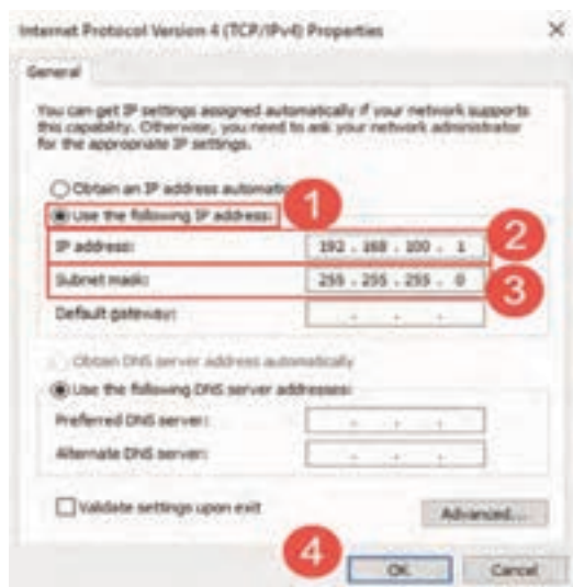
شکل ۹- تنظیمات IP address و Subnet mask
