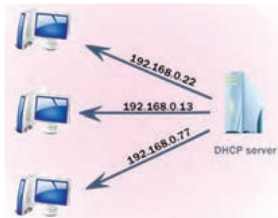
شکل ۳۰- اختصاص خودکار آدرس به سرویس‌گیرنده به وسیله سرور DHCP
