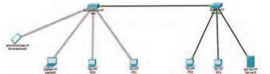
شکل ۲۵- اتصال شبکه بی سیم به شبکه سیمی
