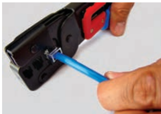
شکل ۲۹- پرس کردن سوکت RJ45
