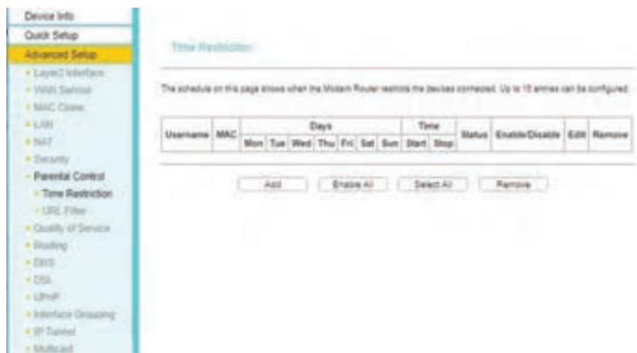
شکل ۶۵- تنظیمات محدودیت دسترسی به مودم
