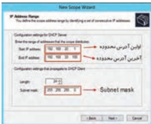
شکل ۳۲- تعیین محدوده آدرس دهی
