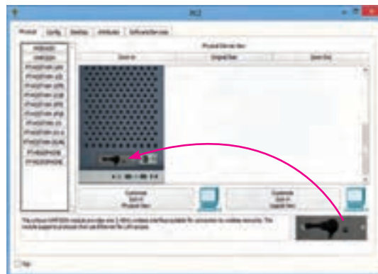
شکل ۱۹- قرار دادن کارت شبکه بی‌سیم
