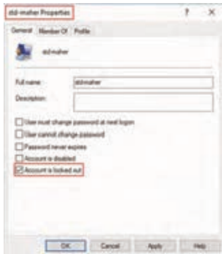
شکل ۳۹- خارج کردن حساب کاربری از حالت lock
