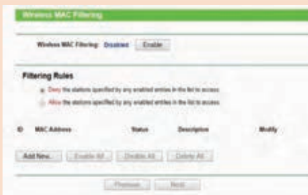
شکل ۳۹- تنظیمات MAC Filtering
