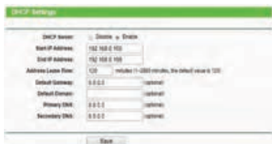
شکل ۴۴- تنظیمات DHCP در Firmware
