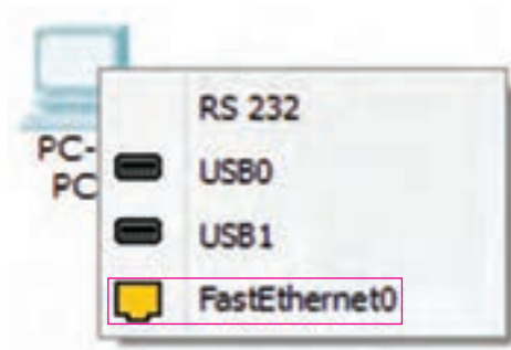
شکل ۶- انتخاب درگاه برای اتصال کابل
