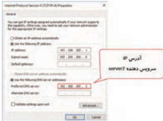
شکل ۲۶- کادر محاوره‌ای تنظیمات کارت شبکه IP
