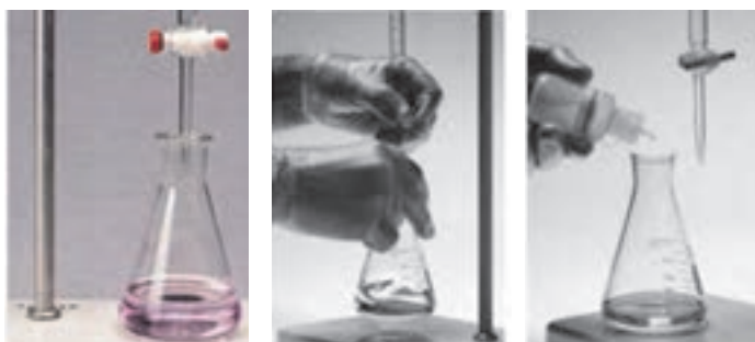
شکل ۱۱- شیوه سنجش حجمی محلول سرکه با سدیم هیدروکسید استاندارد
