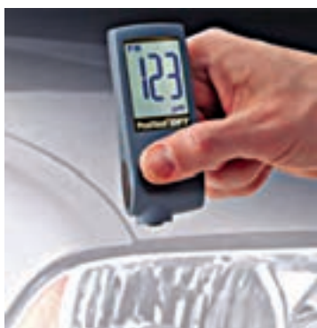
شکل ۲۲- انواع ضخامت سنج فیلم خشک رنگ (غیر تخریبی)
