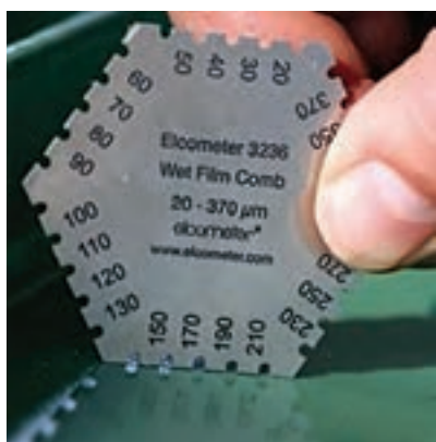
شکل ۱۹- شانه مخصوص اندازه‌گیری ضخامت فیلم تر رنگ
