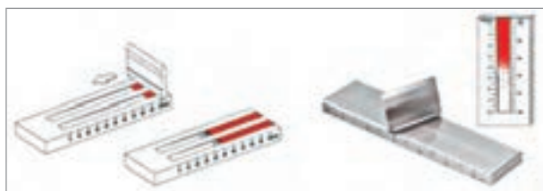
شکل ۱۷- وسیلهٔ اندازه‌گیری دانه‌بندی رنگ تر
