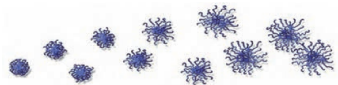
شکل ۱۱- از چپ به راست با افزایش دما مواد اصلاح کننده شاخص گرانروی با باز کردن شاخه‌ها، کاهش گرانروی روغن را جبران می‌کنند.
