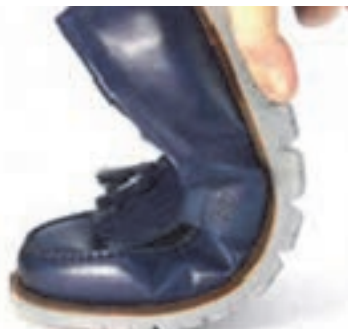
شکل ۱۲- انعطاف‌پذیری در مواد بسیاری پس از افزودن نرم‌کننده و شیوه قرار گرفتن مولکول‌های نرم‌کننده بین زنجیرهای بسیار
