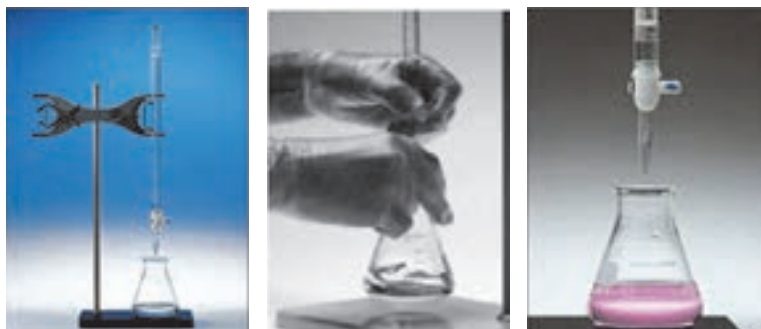
شکل ۱۰- طرح ساده‌ای از آزمایش سنجش حجمی
