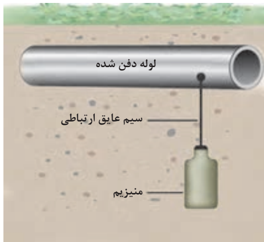
شکل ۲۱- حفاظت لوله آهنی در خاک به روش آند فدا شونده
