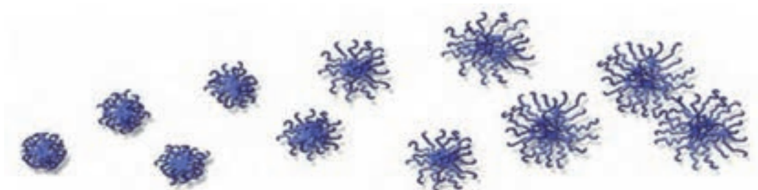
شکل ۱۱- از چپ به راست با افزایش دما مواد اصلاح کننده شاخص گران روی با باز کردن شاخه‌ها، کاهش گران روی روغن را جبران می‌کنند.
