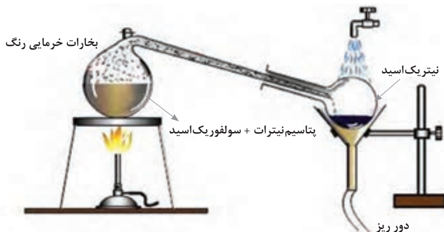
شکل ۷- سامانه تهیه نیتریک اسید
