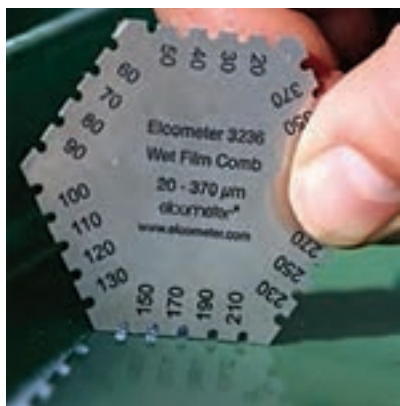
شکل ۱۹- شانه مخصوص اندازه‌گیری ضخامت فیلم تر رنگ
