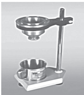
شکل ۱۶- فنجان‌های مختلف اندازه‌گیری گرانروی
