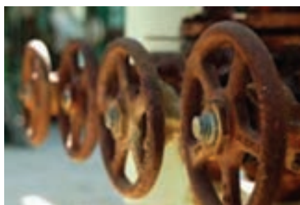
شکل ۵- نمونه‌هایی از خوردگی در قطعه‌های فلزی
