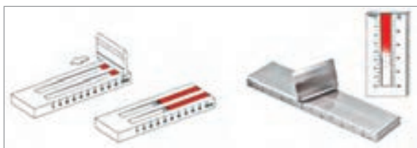
شکل ۱۷- وسیلهٔ اندازه‌گیری دانه‌بندی رنگ تر
