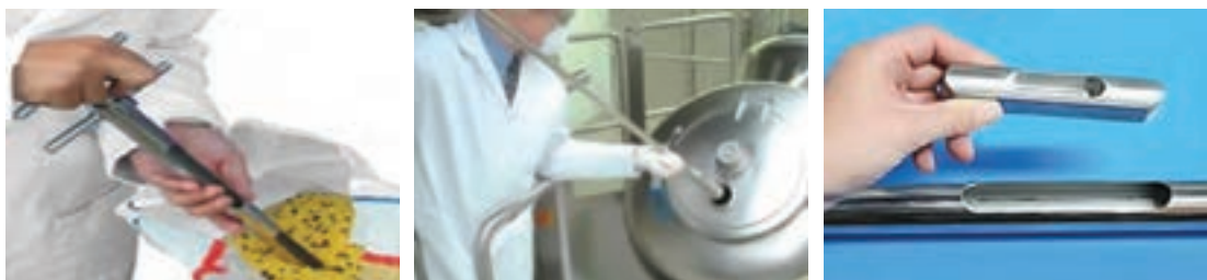
شکل ۸- نمونه گیرهای مخروطی
