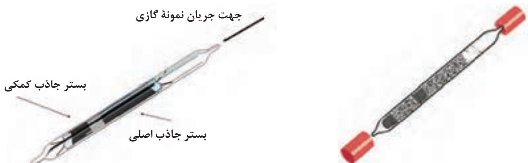
شکل ۲۰- لوله جذب سطحی حاوی زغال فعال
