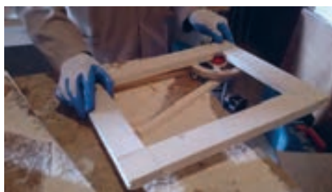
شکل ۴۰- پرداخت با تیغ نیم‌گرد و به کمک دستگاه اورفرز دستی
