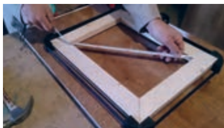
شکل ۳۹- کنترل دوئیدگی و صحیح بودن قاب
