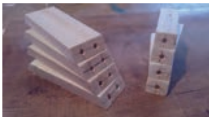
شکل ۴۷- سوراخ کردن قیدها تحت زاویه
