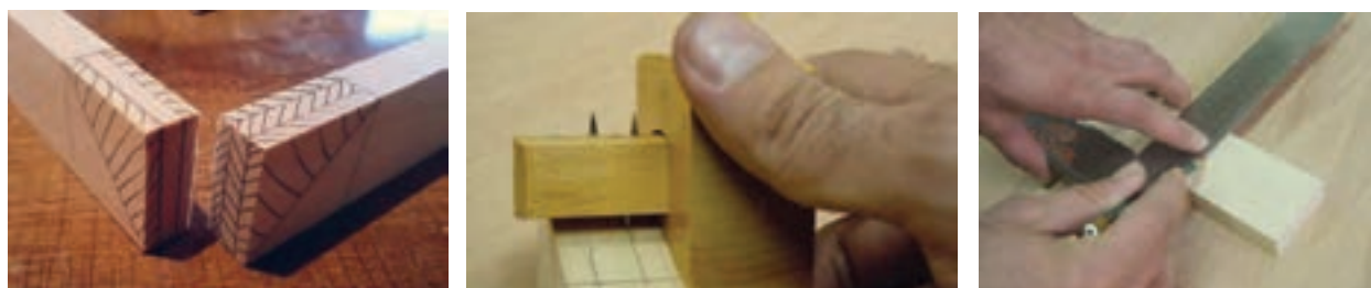
شکل ۳۳- اندازه‌گذاری و خط‌کشی اتصال قاق و زبانه دو رو فارسی
