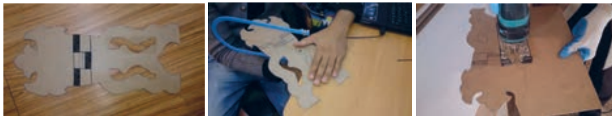
شکل ۵۷- تهیه شابلون رحل چوبی به وسیله اره عمودبر و اره کمائی (مویی)
