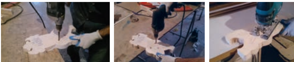
شکل ۶۰- عمل سوراخ‌کاری وسط رحل با دریل دستی
