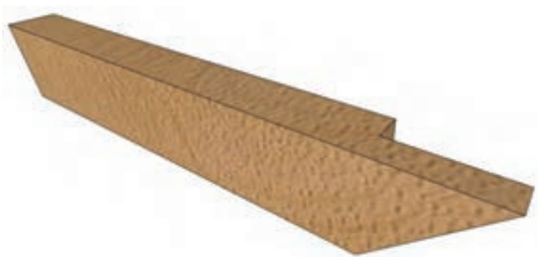
شکل ۲۴ - اتصال نیم و نیم فارسی
