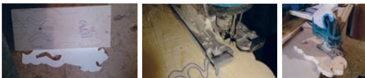
شکل ۵۹- عملیات برشکاری با اره عمودبر
