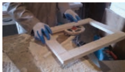
شکل ۴۰- پرداخت با تیغ نیم‌گرد و به کمک دستگاه اورفرز دستی
