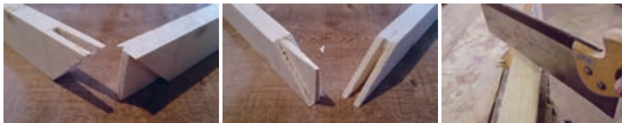
شکل ۳۴- برشکاری اتصال دو رو فارسی
