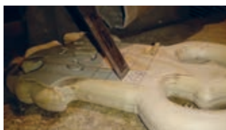
شکل ۶۵- مغارکاری مفصل‌ها به صورت غلط
