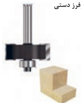
شکل ۴۱- دو راهه کردن با دستگاه اورفرز دستی و تیغ دو راهه
