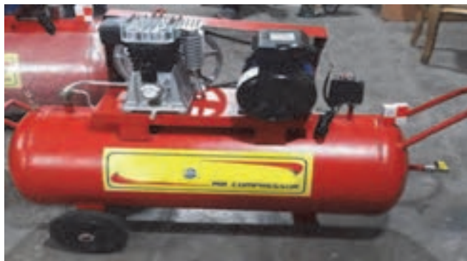
شکل ۱۹۰- هیچ گاه کمپرسور را به پهلو نخواستارید
