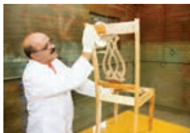
شکل ۵۹- زدن روغن بزرک با کهنه
