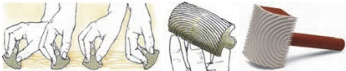
شکل ۱۶۰- روش صحیح استفاده از نقش‌انداز
