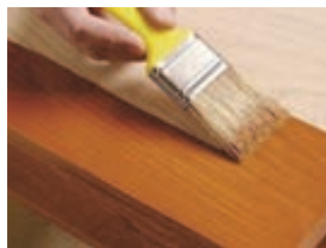
شکل ۵۷- روغن اندود کردن سطح کار
