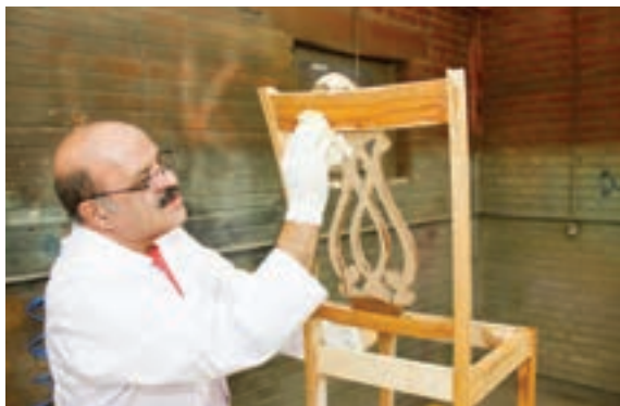
شکل ۱۴۶- زدن سیلر با کهنه رنگ‌کاری
