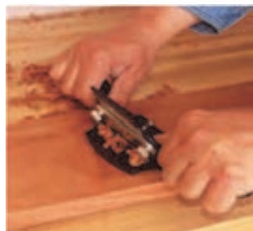
شکل ۱۰۹- پرداخت کاری روی چوب
