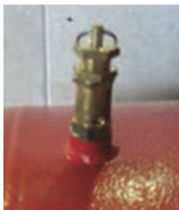
شکل ۱۸۹- سوپاپ کمپرسور برای خروج هوای اضافی
