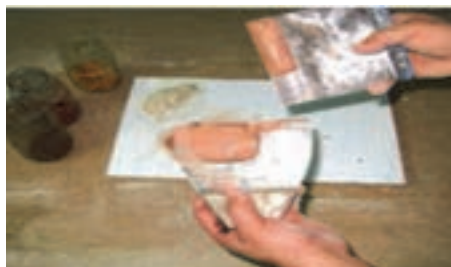
شکل ۴۶- ساخت بتونه هم‌رنگی
