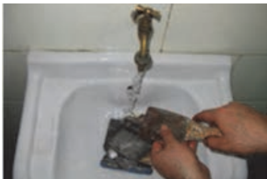
شکل ۱۴۰- شستن و تمیز کردن لیسه و کاردک
