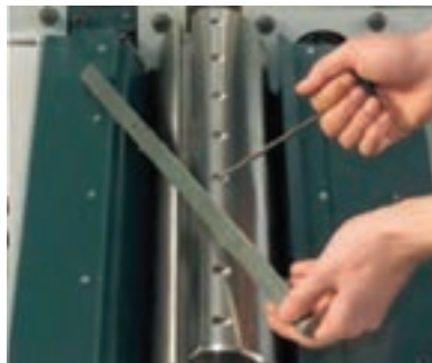
شکل ۲۷- روش تعویض تیغه رنده و نحوه قرار گرفتن تیغه و استقرار آن روی تویی
