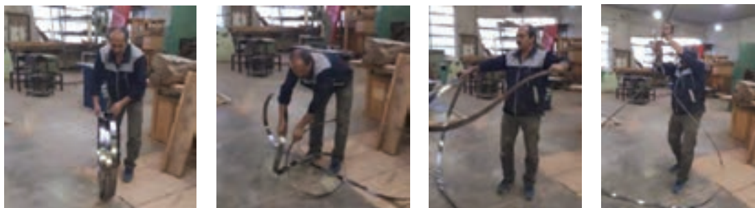
شکل ۱۹- روش جمع کردن تیغه اره نواری
