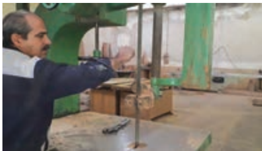
شکل ۱۸- کنترل سفتی تیغه پس از تعویض و اطمینان از استقرار صحیح آن روی فلک‌ها
