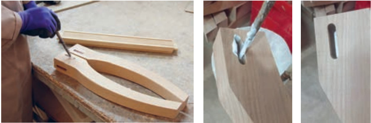
شکل ۶۴- چسب زدن کام پایه‌ها
