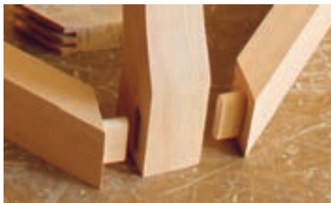
شکل ۱۰- اتصال و زبانه مخفی
