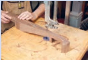
شکل ۴۹- قوس بری چوب: مرحله دوم
