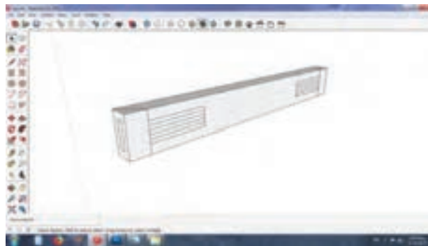
شکل ۲۴- ترسیم اتصالات شانه‌ای
