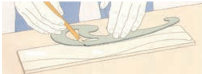
شکل ۴۲- آماده کردن الگوی پایه به وسیله پیستوله
