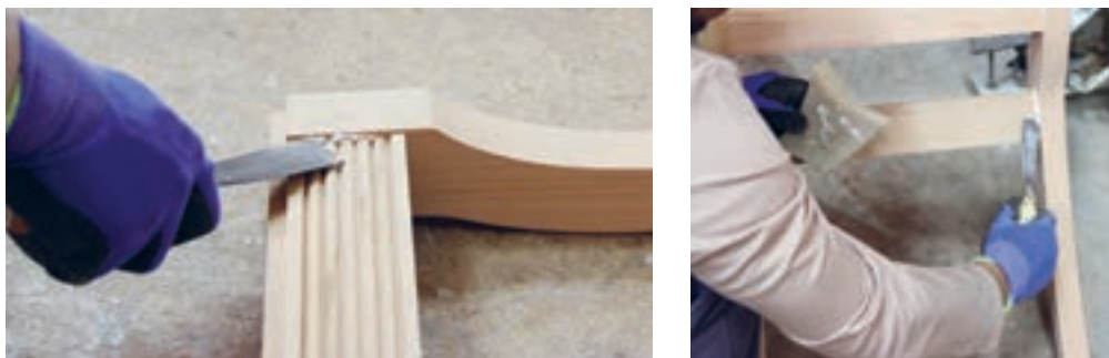
شکل ۶۷- تمیز کردن چسب اضافی با کاردک
