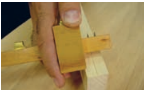
شکل ۵۳- اندازه‌گذاری به وسیله خط‌کش تیره‌دار
