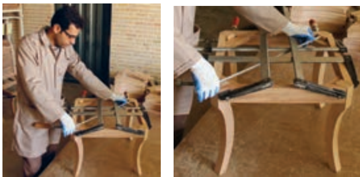
شکل ۶۹- کنترل دوئیدگی با متر
