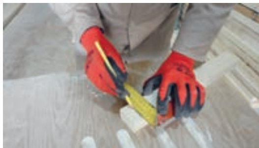
شکل ۵۲- اندازه‌گذاری به وسیله گونیا
