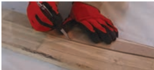
شکل ۴۳- انتقال الگوی پایه میز عسلی، از شابلون به روی چوب
