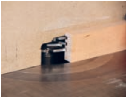
شکل ۶۱- تیغ فرز مخصوص زهوار صفحه
