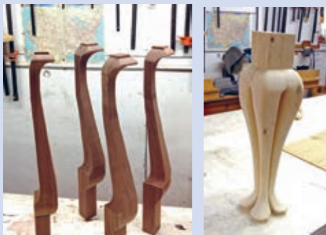
شکل ۵۱- آماده شدن پایه‌ها برای ایجاد کام
