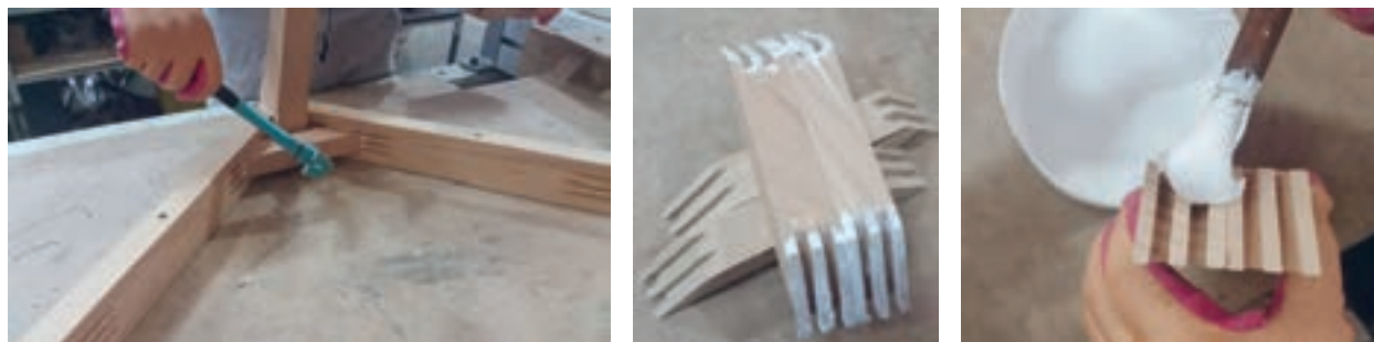
شکل ۶۸- چسب زدن و جا زدن نبشی‌ها با چکش
