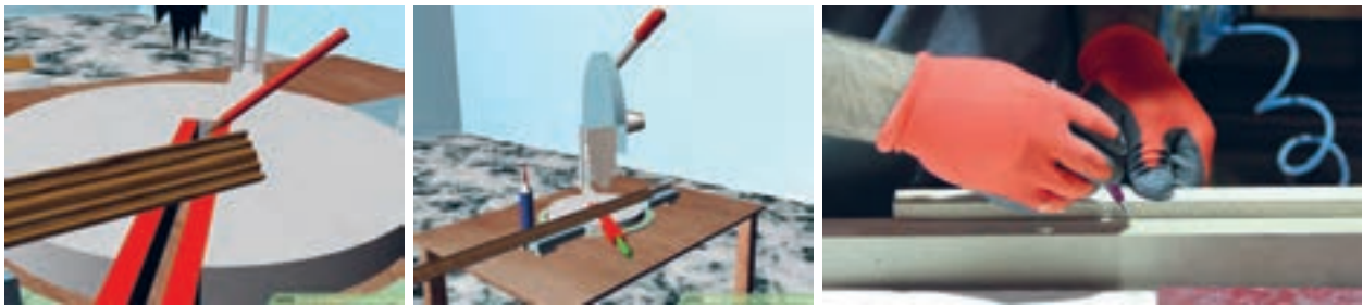
شکل ۷۳- اندازه‌گیری و برش زهوار دور میز عسلی
