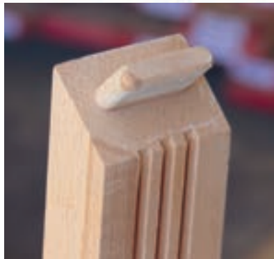
شکل ۵۹- اتصال کام تحت زاویه ۴۵ درجه
