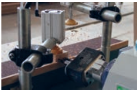
شکل ۵۷- دوبل زدن چوب با دستگاه دوبل نیمه اتوماتیک
