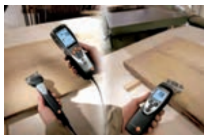
شکل ۶- دستگاه رطوبت سنج نوع دی الکتریک
