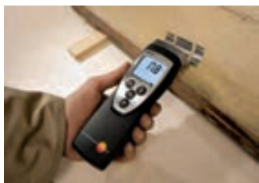
شکل ۶- دستگاه رطوبت سنج نوع دی الکتریک
