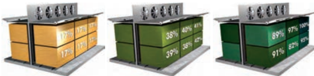
شکل ۶۸- مراحل مختلف خشک کردن چوب در کوره
