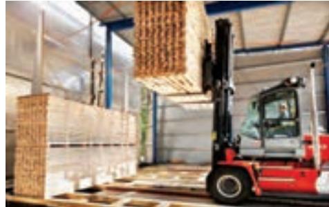
شکل ۲۳- سیستم بارگیری کوره به وسیله لیفت‌تراک
