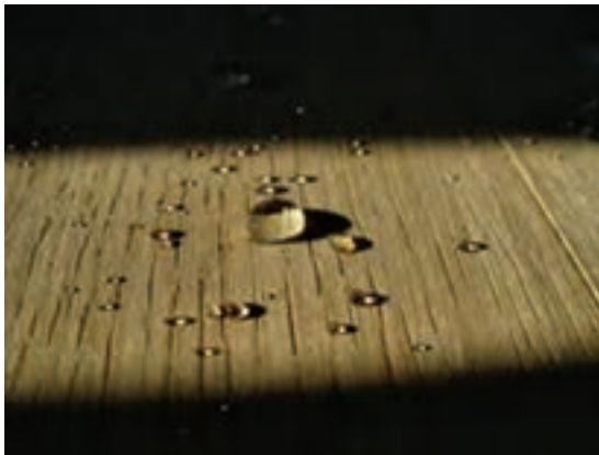
شکل ۷۲- نمونه چوب ضدآب شده با کمک نانوذرات
