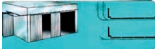
شکل ۳۲- در ریلی برای کوره‌های با پهنا ۱۳ متر
