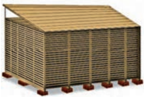
شکل ۱۷- پوشش واحد دسته بندی به وسیله پوشش یا آفتاب گیر
