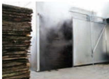
شکل ۶۹- خروج چوب‌های خشک شده از کوره
