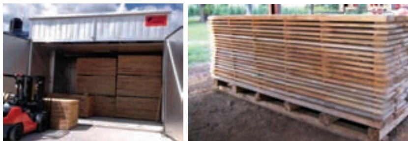
شکل ۶۶- بارگیری دسته‌بندی‌های چوب به طریق عرضی
