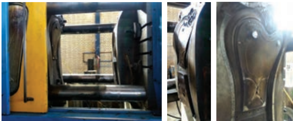
شکل ۷۴- قالب‌های مورد استفاده در ساخت مبل پلیمری
