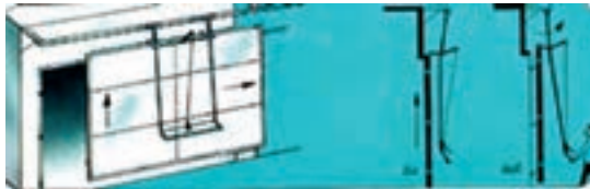
شکل ۳۲- در ریلی برای کوره‌های با پهنا ۱۳ متر
