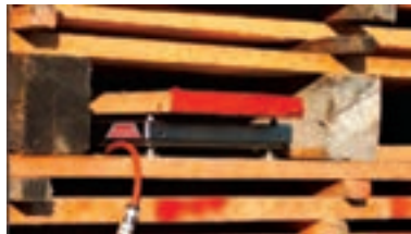
شکل ۵۹- نمونه کنترل در کوره
