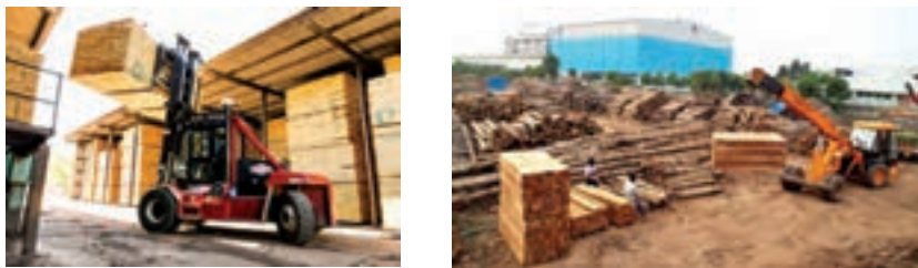
شکل ۱۶- جابه جا کردن واحد دسته بندی به وسیله لیفتراک (سمت چپ) و جرثقیل (سمت راست)
