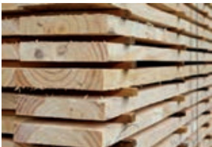
شکل ۱۳- روش چوب‌دستک‌گذاری در دسته‌های چوب
