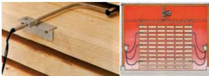
شکل ۶۳- سنسورهای اندازه‌گیری جریان هوا و موقعیت آنها در کوره
