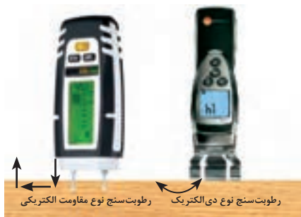
شکل ۸- روش کار رطوبت سنج های الکتریکی
