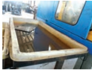
شکل ۷۵- حوضچه آب کنار دستگاه تزریق
