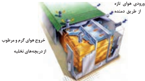
شکل ۴۵- کوره چوب خشک‌کنی مجهز به سیستم جریان اجباری هوا با دمنده خارجی
