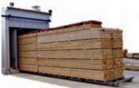
شکل ۲۴- سیستم بارگیری کوره به وسیله ریل و واگن
