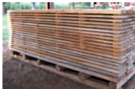
شکل ۱۳- روش چوب‌دستک‌گذاری در دسته‌های چوب
