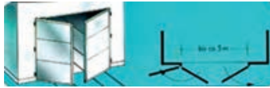
شکل ۳۰- در بادبزی تکی یا دوتایی برای کوره‌های کوچک با پهنا ۵ تا ۳ متر
