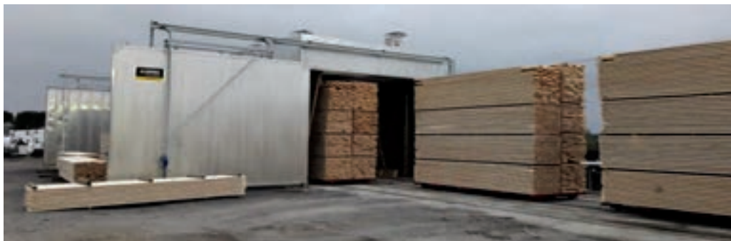
شکل ۶۵- بارگیری دسته‌بندی‌های چوب به طریق طولی
