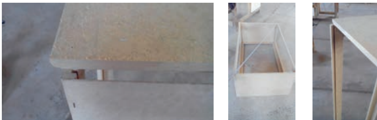
شکل ۷۸- کنترل دوئیدگی و بترین قبل از پشت کوبی (شیار آینه قابل مشاهده است)
