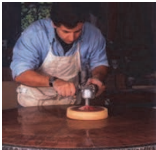
شکل ۴۷- پولیش کاری سطح پلی‌استر خورده
