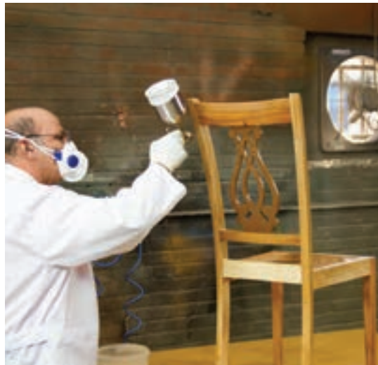
شکل ۴۳- زدن پلی استر با پیستوله
