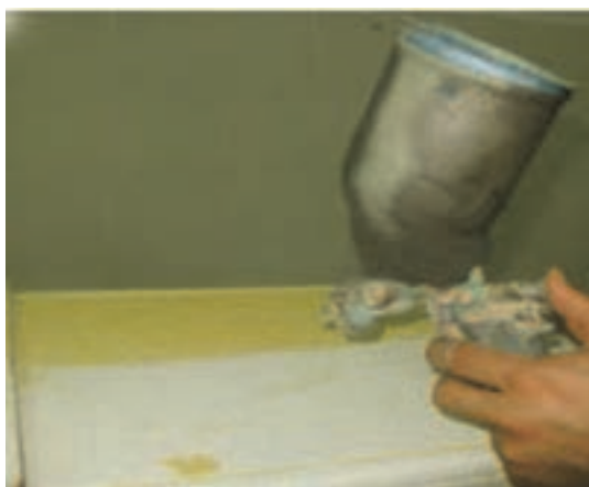
شکل ۲۹- پاشیدن رنگ نیترو سلولزی با پیستوله
