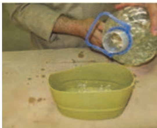
شکل ۳۰- استفاده از تینر فوری برای رقیق کردن سیلر
