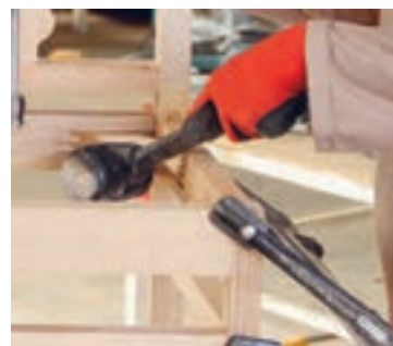
شکل ۱۰۷- جا زدن نبشی به وسیله چکش پلاستیکی
