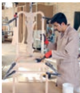
شکل ۱۰۷- جا زدن نبشی به وسیله چکش پلاستیکی
