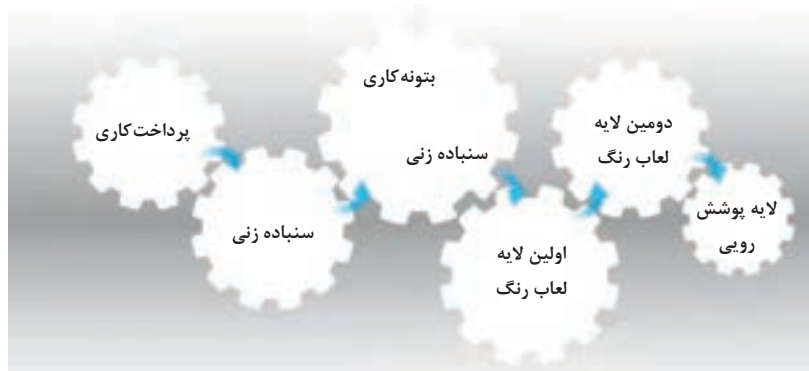
شکل ۱۱۵- مراحل اجرای رنگ کاری
