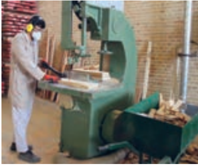
شکل ۷۵- نحوه استقرار جلوی اره نواری در موقع برش کاری با استفاده از گونیا
