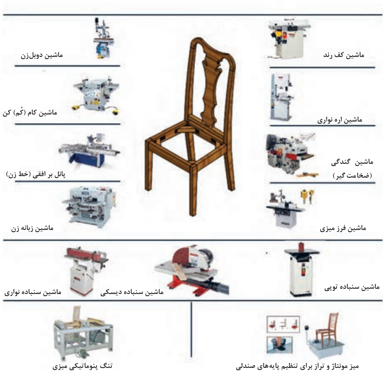
شکل ۲۵- ماشین آلات مورد استفاده در ساخت پروژه
