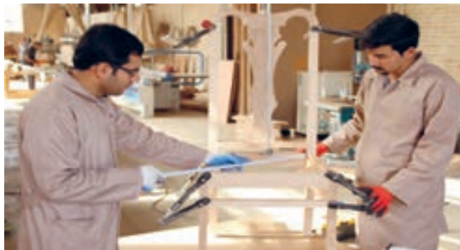
شکل ۱۰۹- کنترل دوئیدگی با متر
