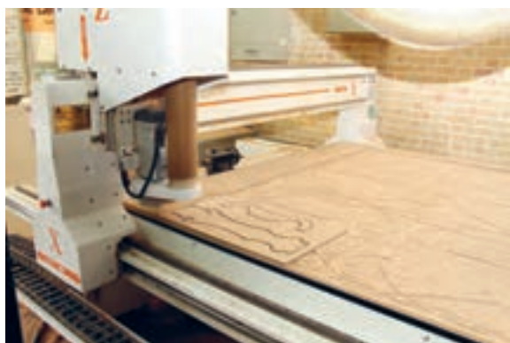
شکل ۶۷- تهیه شابلون با دستگاه فرز CNC
