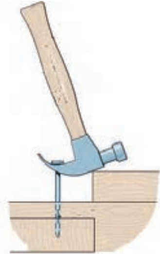
شکل ۱۵- نحوه صحیح کشیدن میخ
