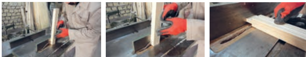
شکل ۹۱- عملیات برش زبانه با دستگاه اره گرد
