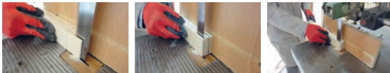
شکل ۹۰- عملیات برش زبانه با دستگاه اره نواری
