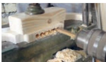
شکل ۸۸- عملیات کم کنی با دستگاه سه کاره
