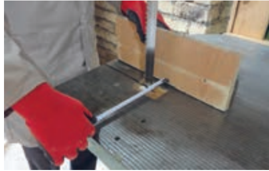
شکل ۷۴- اندازه گیری فاصله تیغه با گونیا
