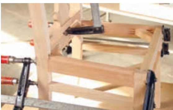
شکل ۱۱۰- نصب نبشی ها
