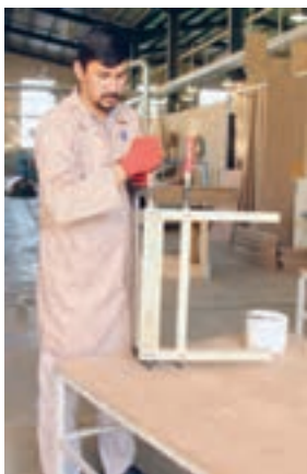
شکل ۱۰۱- استفاده از چکش لاستیکی برای جا زدن زبانه‌ها و مراحل مونتاژ پایه‌ها و قیده‌های جلو
