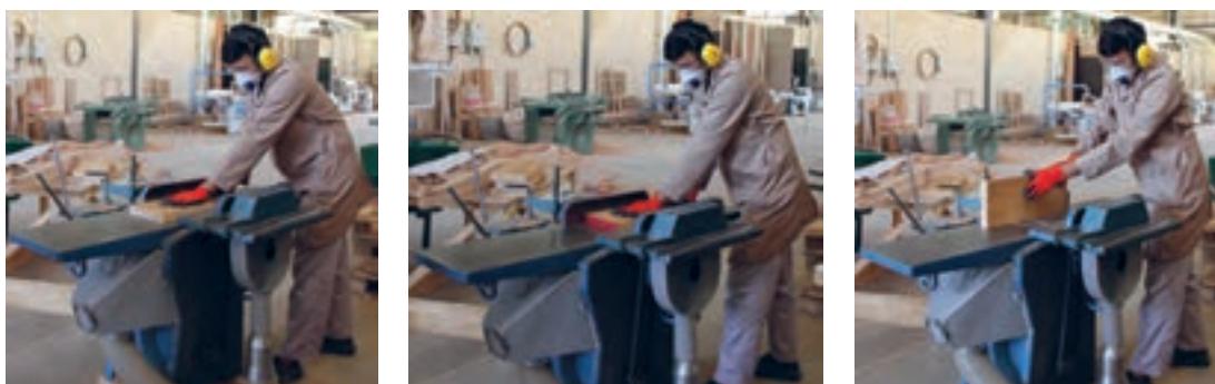
شکل ۷۰- یک رو و یک نرکردن چوب
