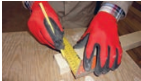
شکل ۸۷- علامت زدن قطعات مختلف برای انجام اتصال
