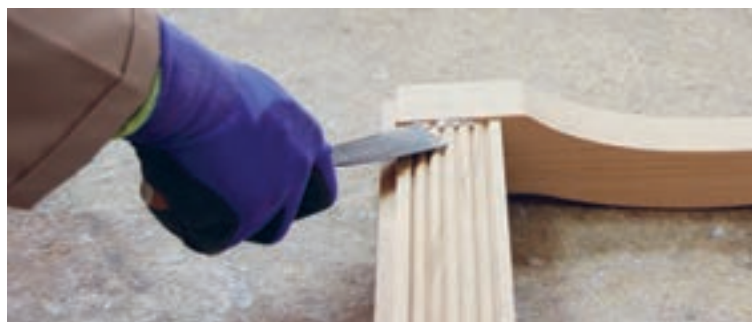
شکل ۱۰۲- تمیز کردن چسب اضافی با کاردک
