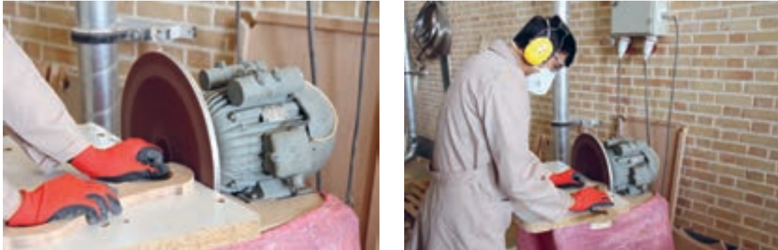
شکل ۸۶- عمل پرداخت قسمت خارجی تاج با سنباده دیسکی
