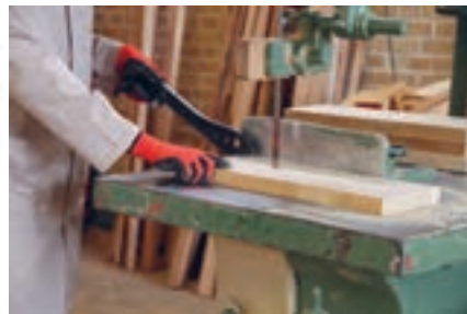
شکل ۷۷- وضعیت گرفتن چوب و هدایت آن با چوب کمکی و ابعاد استاندارد چوب کمکی
