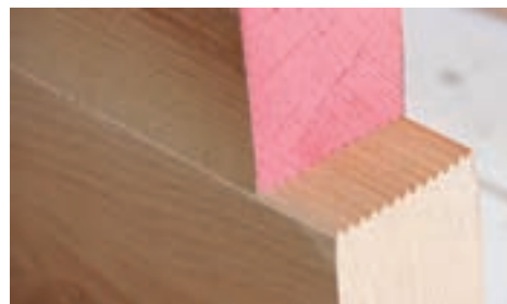
شکل ۱۳- اتصال انگشتی ساخته شده با دستگاه فرز
