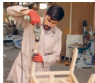
شکل ۱۱۲- سوراخکاری کف پایه با دریل
