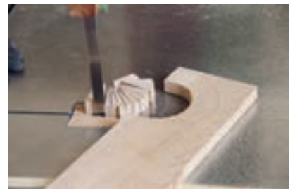
شکل ۸۱- عمل قوس‌بری (الف) به روش برش مستقیم از خارج کار (ب) به روش قوس‌بری از گوشه مماس بر دایره
