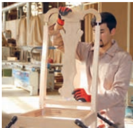
شکل ۱۰۵- اندازه‌گیری دوبل و نصب تاج و پشتی به صندلی
