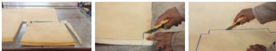
شکل ۴- برش کاری اسفنج کفی صندلی
