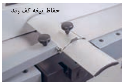
شکل ۳- نمونه‌هایی از حفاظ‌های مخصوص تیغه هر دستگاه
