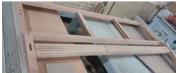
شکل ۵۰- جا زدن پشتی مبل با تنگ پنوماتیکی
