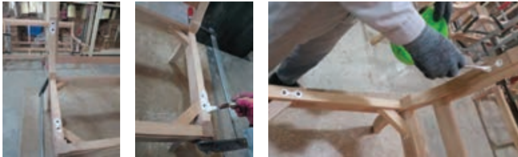
شکل ۵۹- چسب زدن محل اتصالات دسته مبل
