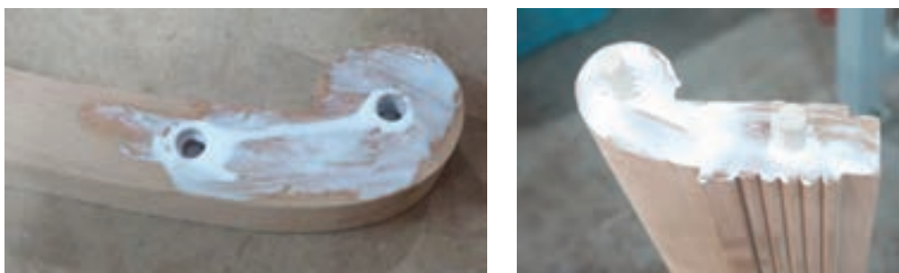
شکل ۴۶- روش چسب زدن اتصال دوبل پایه‌های عقب
