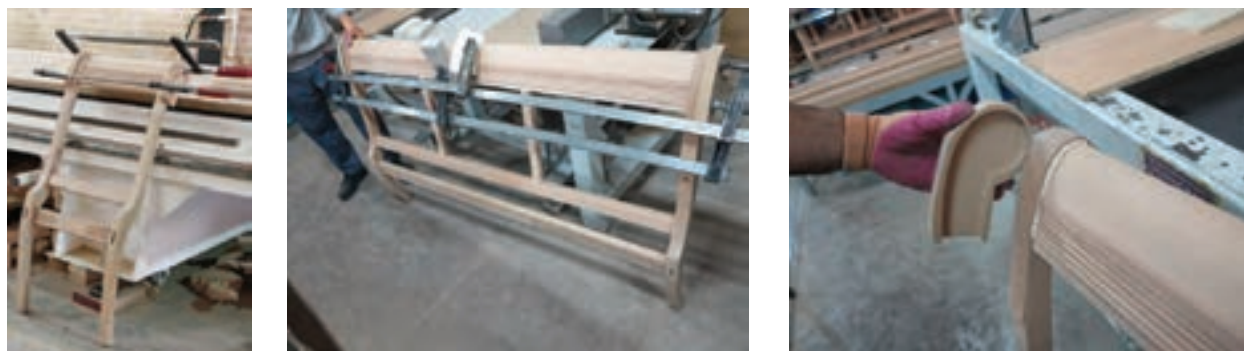
شکل ۵۱- بستن پشتی مبلی توسط گیره دستی (پیچ دستی)
