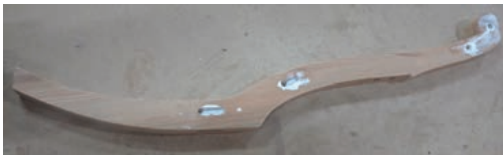
شکل ۴۶- روش چسب زدن اتصال دوبل پایه‌های عقب
