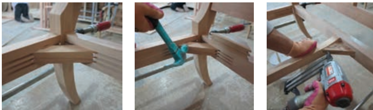
شکل ۵۸- جا زدن نبشی‌های گوشه
