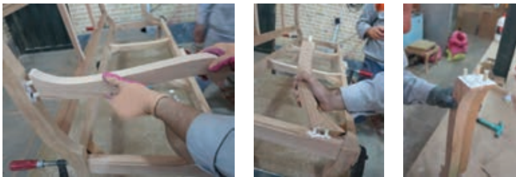
شکل ۶۰- جا زدن دسته مبل در محل اتصالات
