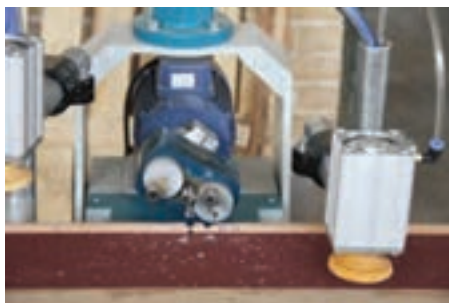
شکل ۳۸- ایجاد اتصال با دستگاه دوپل زن نیمه‌اتوماتیک
