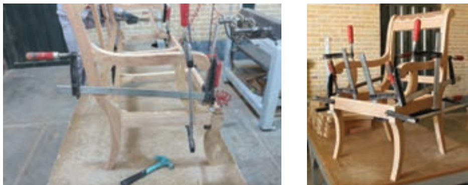
شکل ۶۲- بستن دسته و زیر دسته با گیره دستی
