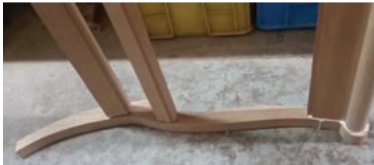
شکل ۴۸- جا زدن پشتی مبل
