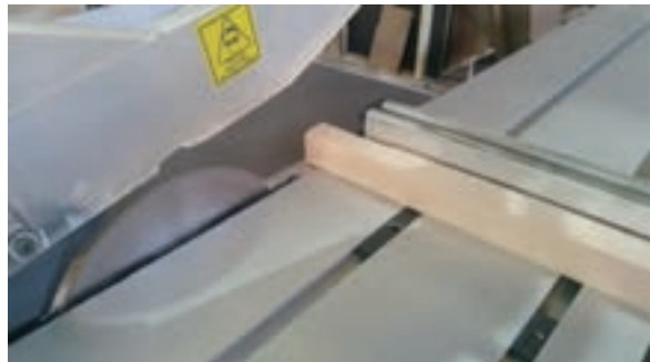
شکل ۳۶- یک اندازه کردن قیدها با دستگاه اره مجموعه‌ای
