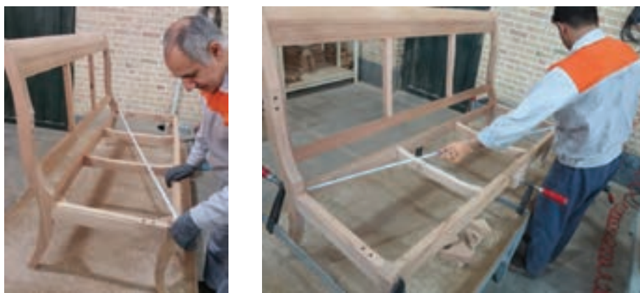
شکل ۵۷- کنترل دوئیدگی (گونیا)ی کردن کار) با متر
