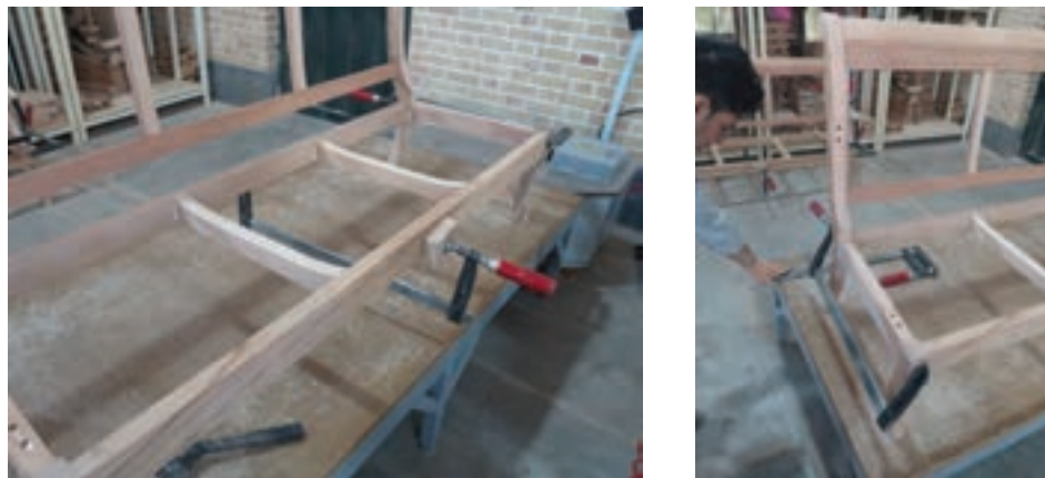
شکل ۵۶- جا زدن اتصالات با گیره دستی
