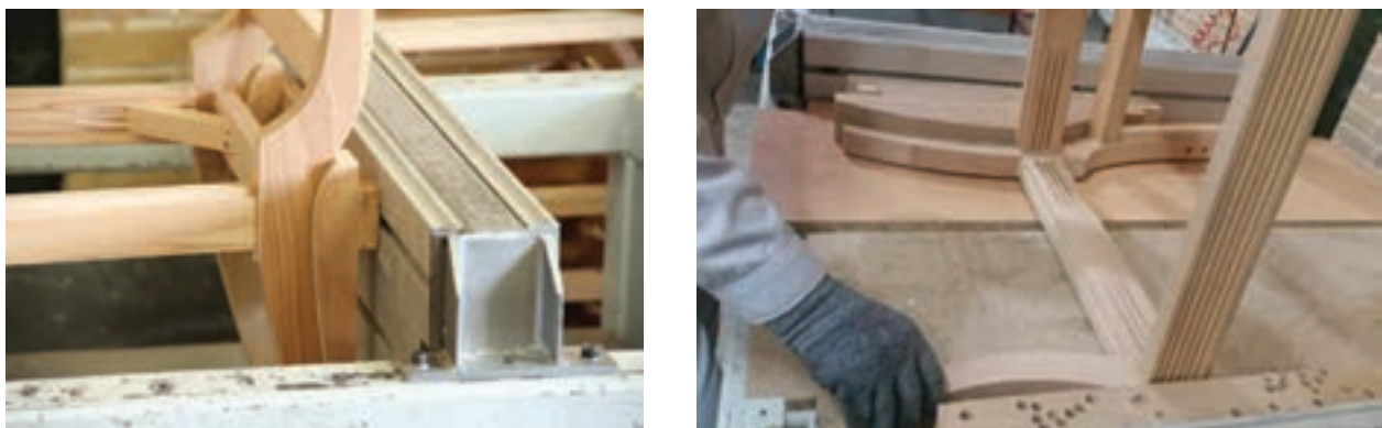
شکل ۵۵- جا زدن اتصالات با تنگ پنوماتیکی
