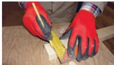
شکل ۸۷- علامت زدن قطعات مختلف برای انجام اتصال
