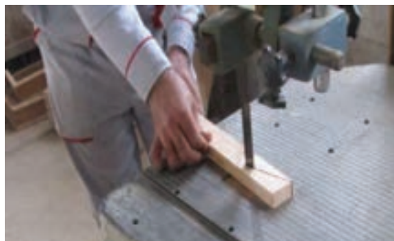
شکل ۶۳- پایان قوس بری با دستگاه اره نواری
