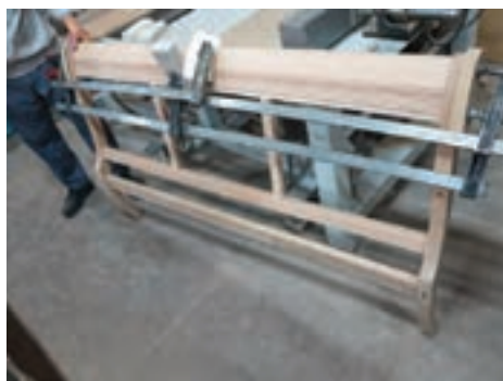
شکل ۵۱- بستن پشتی مبل توسط گیره دستی (پیچ دستی)
