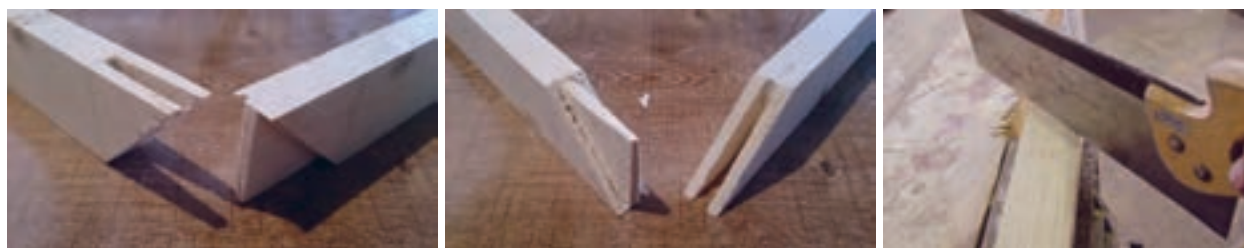
شکل ۳۴- برشکاری اتصال دو رو فارسی
