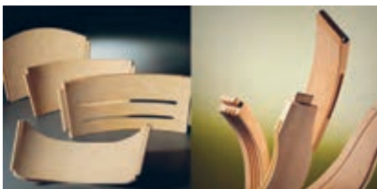
شکل ۸- انواع اتصالات مختلف کام و زبانه
