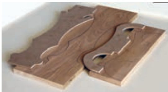
شکل ۸۰- انتقال الگوی تاج و پشتی، از روی شابلون به روی چوب
