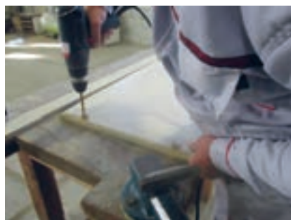
شکل ۶۶- عملیات اتصال دابل به وسیله دریل دستی
