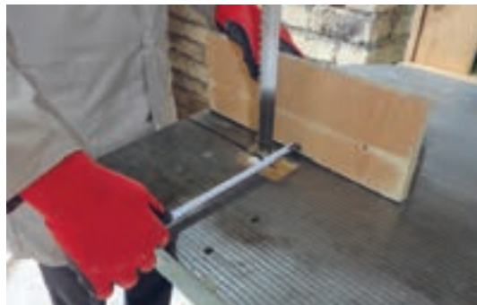
شکل ۷۴- اندازه‌گیری فاصله تیغه با گونیا
