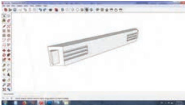
شکل ۲۵- حجم دادن به اتصال شانه‌ای
