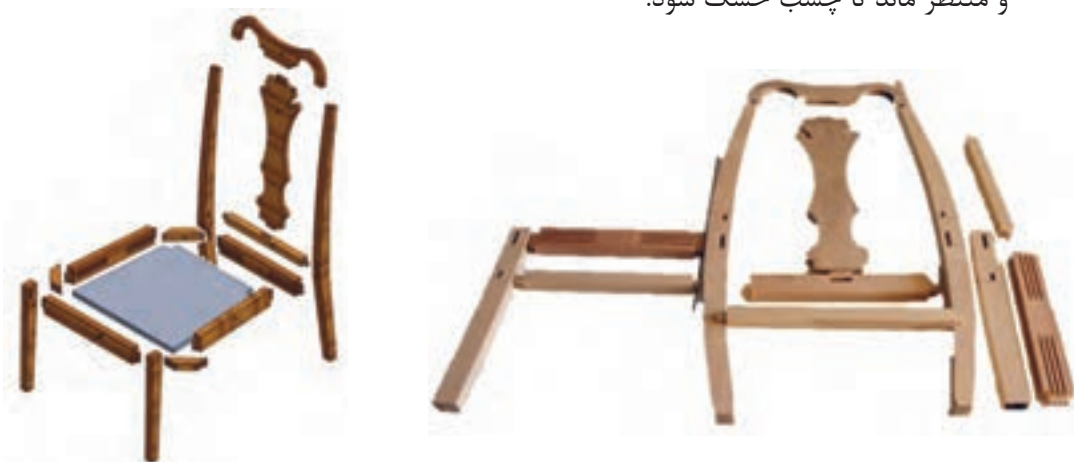
شکل ۹۶- قطعات آماده مونتاژ صندلی
