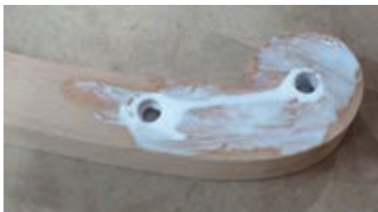
شکل ۴۶- روش چسب زدن اتصال دوبل پایه‌های عقب
