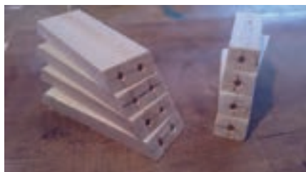
شکل ۴۷- سوراخ کردن قیدها تحت زاویه
