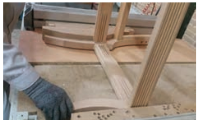
شکل ۵۵- جا زدن اتصالات با تنگ پنوماتیکی
