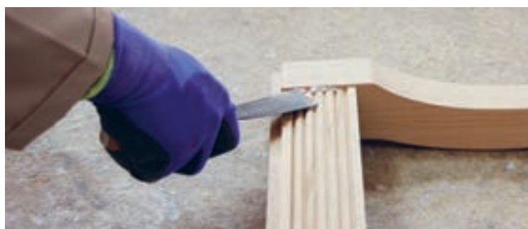
شکل ۱۰۲- تمیز کردن چسب اضافی با کاردک
