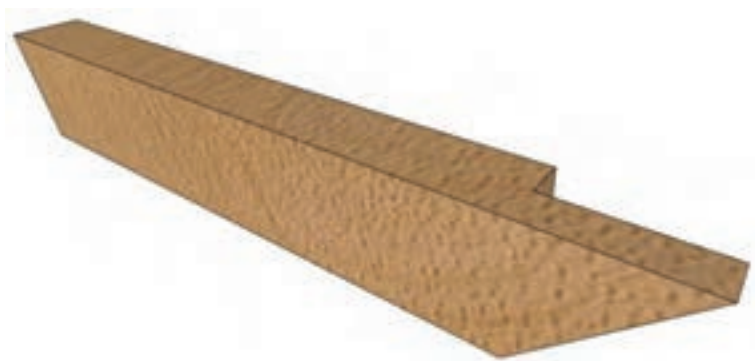
شکل ۲۴ - اتصال نیم و نیم فارسی
