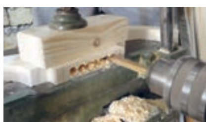
شکل ۸۸- عملیات کم کنی با دستگاه سه کاره
