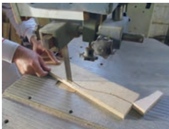
شکل ۶۲- عملیات قوس‌بری با دستگاه اره نواری
