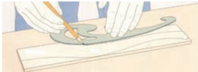
شکل ۴۲- آماده کردن الگوی پایه به وسیله پیستوله
