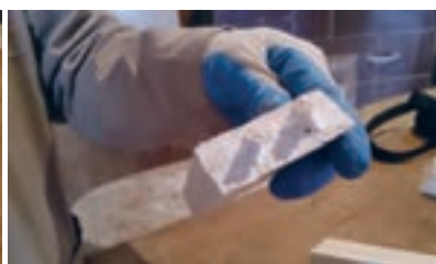
شکل ۵۰- چسب زدن سطح قیدها و جا زدن میخ چوبی در محل اتصال
