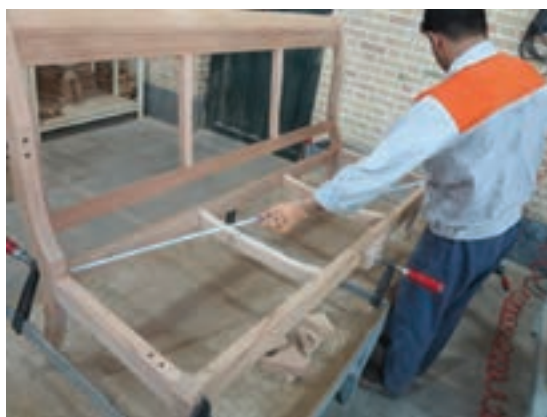
شکل ۵۷- کنترل دوئیدگی (گونیا) کردن کار) با متر
