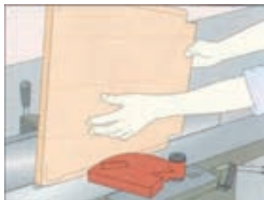
پرداخت کردن کفی با دستگاه کفرند
