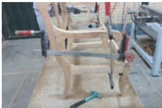
شکل ۶۲- بستن دسته و زیر دسته با گیره دستی
