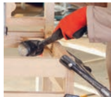
شکل ۱۰۷- جا زدن نبشی به وسیله چکش پلاستیکی
