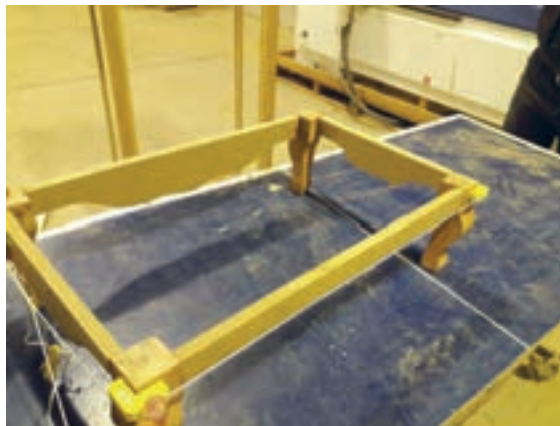
شکل ۷۱- مونتاژ به وسیله گیره کمربندی
