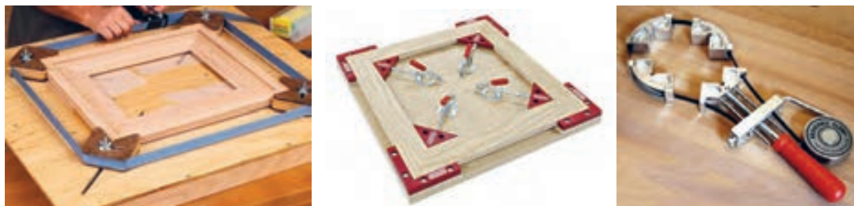
شکل ۷۲- گیره مخصوص بستن قاب
