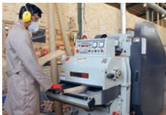
شکل ۷۸- نحوه گندگی کردن چوب‌های کم عرض
