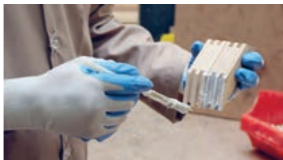
شکل ۱۰۸- چسب زدن نبشی‌ها
