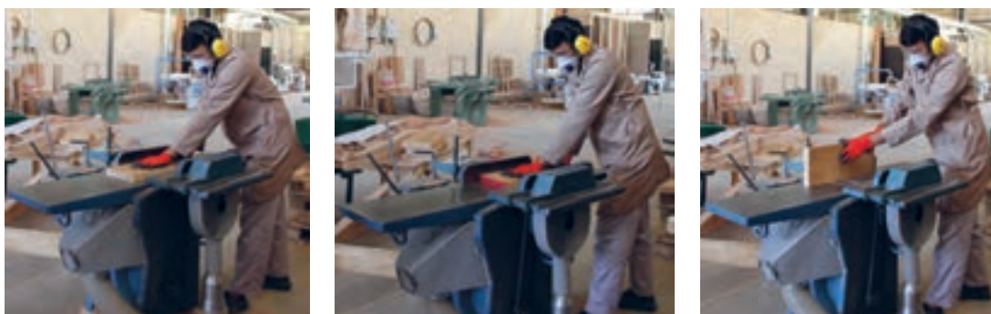
شکل ۷۰- یک رو و یک نرکردن چوب
