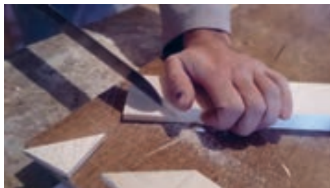
شکل ۳۰- عملیات برشکاری اتصال نیم و نیم یک رو فارسی
