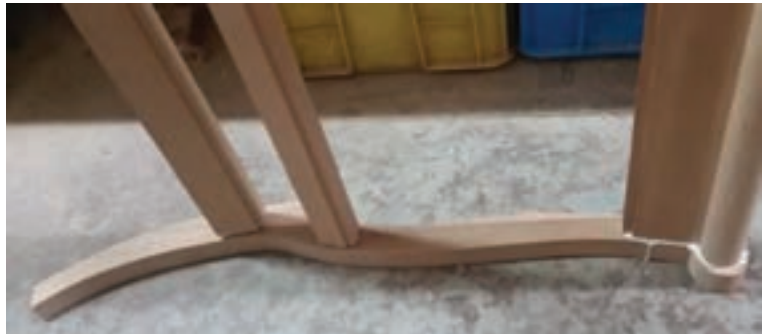
شکل ۴۸- جا زدن پشتی مبل
