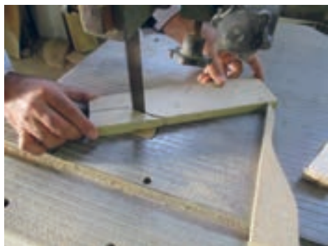
شکل ۶۳- پایان قوس بری با دستگاه اره نواری
