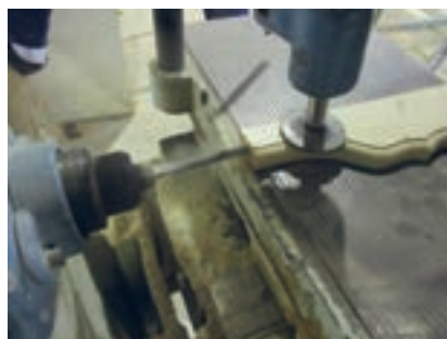
شکل ۶۵- عملیات اتصال دابل با دستگاه کم کن
