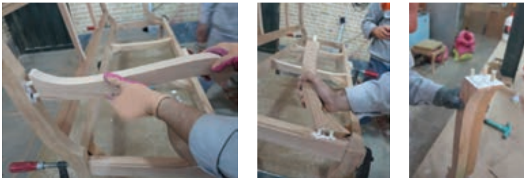
شکل ۶۰- جا زدن دسته مبل در محل اتصالات
