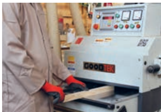
شکل ۷۸- نحوه گندگی کردن چوب‌های کم عرض
