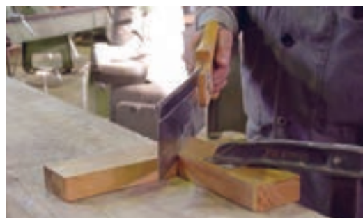
شکل ۳۵ - چگونگی اهر کشی درز بین اتصال
