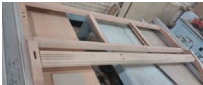
شکل ۵۰- جا زدن پشتی مبل با تنگ پنوماتیک
