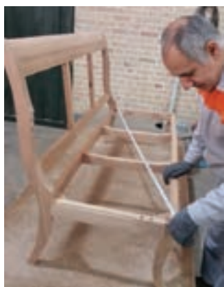
شکل ۵۷- کنترل دوئیدگی (گونیا) کردن کار) با متر
