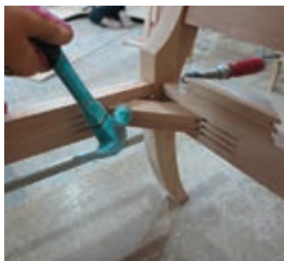
شکل ۵۸- جا زدن نبشی‌های گوشه
