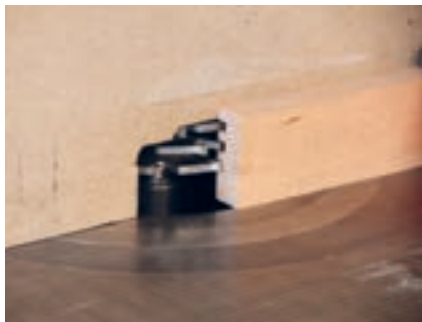
شکل ۶۱- تیغ فرز مخصوص زهوار صفحه
