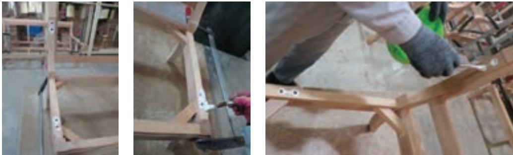
شکل ۵۹- چسب زدن محل اتصالات دسته مبل
