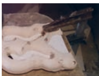
شکل ۶۴- ثابت کردن رحل چوبی به میز کار
