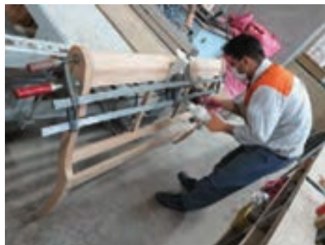
شکل ۵۲- تمیز کردن چسب اضافی روی قطعه کار
