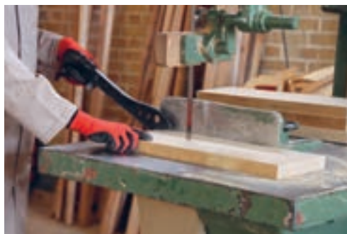
شکل ۴۰- وضعیت برش چوب قیدها
