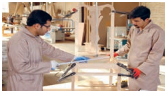
شکل ۱۰۹- کنترل دوئیدگی با متر
