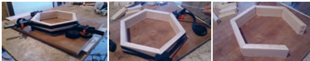
شکل ۵۱- جا زدن قیدها و بستن با گیره تسمه‌ای
