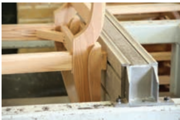
شکل ۵۵- جا زدن اتصالات با تنگ پنوماتیکی
