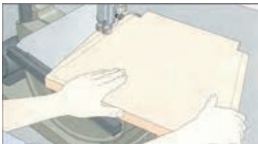
بریدن کفی توسط دستگاه اره نواری
