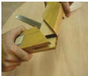
شکل ۳۲- چگونگی خط کشی و مونتاژ اتصال یک رو فارسی
