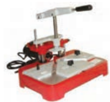
شکل ۶۷- دستگاه دم چلچله زن
