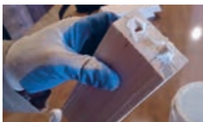
شکل ۴۹- چسب زدن اتصال دوبل
