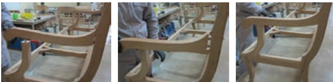
شکل ۶۱- کنترل صحیح بودن دسته مبل
