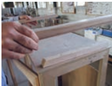
شکل ۸۱- نصب تاج به بدنه
