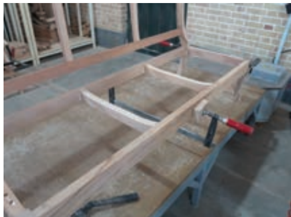
شکل ۵۶- جا زدن اتصالات با گیره دستی
