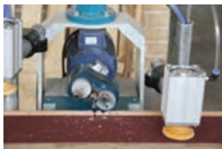
شکل ۳۸- ایجاد اتصال با دستگاه دو بل زن نیمه‌اتوماتیک
