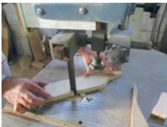
شکل ۶۲- عملیات قوس‌بری با دستگاه اره نواری
