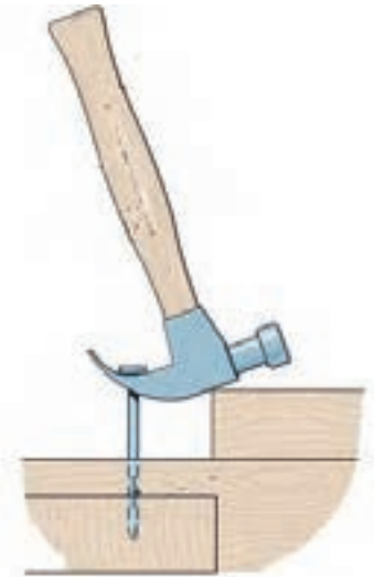
شکل ۱۵- نحوه صحیح کشیدن میخ
