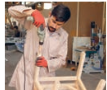
شکل ۱۱۲- سوراخکاری کف پایه با دریل
