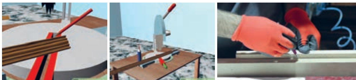
شکل ۷۳- اندازه‌گیری و برش زهوار دور میز عسلی
