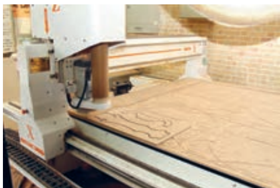
شکل ۶۷- تهیه شابلون با دستگاه فرز CNC
