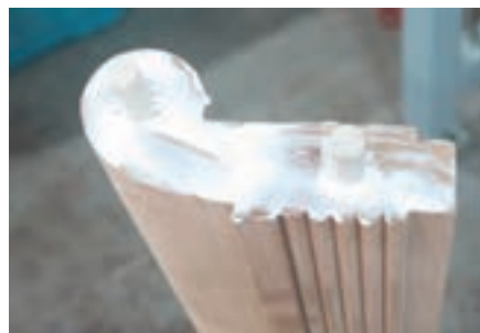
شکل ۴۶- روش چسب زدن اتصال دوبل پایه‌های عقب
